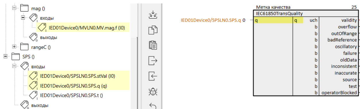
Рисунок 4.10 – Подключение метки качества к IEC61850TransQuality
