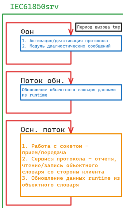
Рисунок 2.5 – Работа IEC61850srv: разделение на потоки и последовательность вызова подпрограмм
