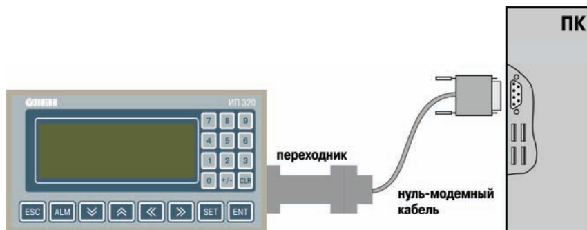
Рис. Б. 1. Подключение панели к компьютеру
