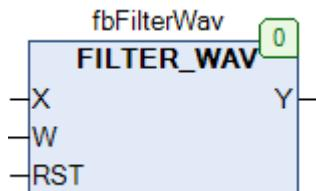
Рис. 19.26. Внешний вид ФБ FILTER\_WAV на языке CFC
