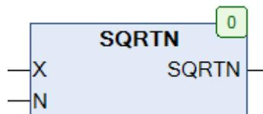
Рис. 5.125. Внешний вид функции **SQRTN** на языке CFC
