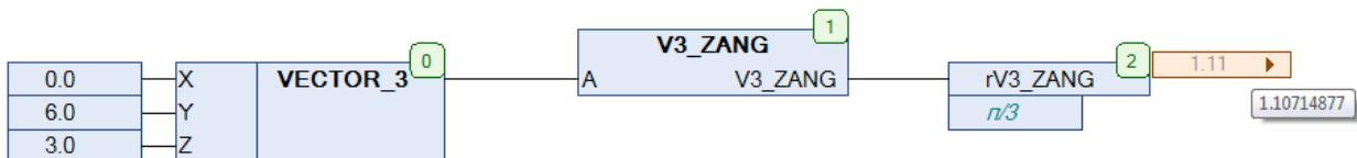
Рис. 11.28. Пример работы с функцией **V3\_ZANG** на языке CFC
