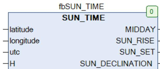
Рис. 12.98. Внешний вид ФБ SUN\_TIME на языке СFC
