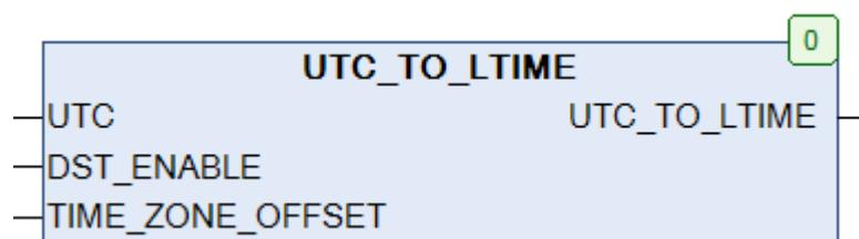
Рис. 12.103. Внешний вид функции **UTC\_TO\_LTIME** на языке CFC
