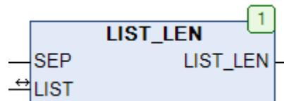
Рис. 26.9. Внешний вид функции LIST\_LEN на языке CFC
