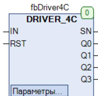
Рис. 24.3. Внешний вид ФБ DRIVER\_4C на языке CFC
