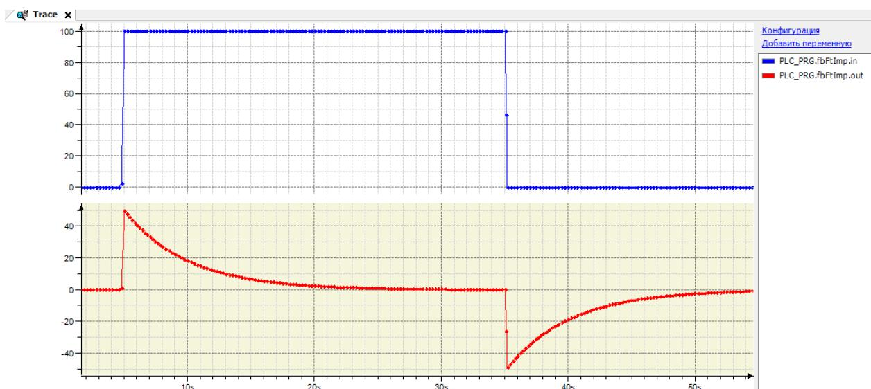
Рис. 23.26. Трассировка работы ФБ FT\_IMP ( $K=0.5$ ,  $T=T\#5s$ )
