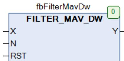
Рис. 19.20. Внешний вид ФБ FILTER\_MAV\_DW на языке CFC
