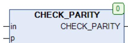
Рис. 16.35. Внешний вид функции **CHECK\_PARITY** на языке CFC
