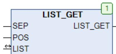
Рис. 26.5. Внешний вид функции LIST\_GET на языке CFC
