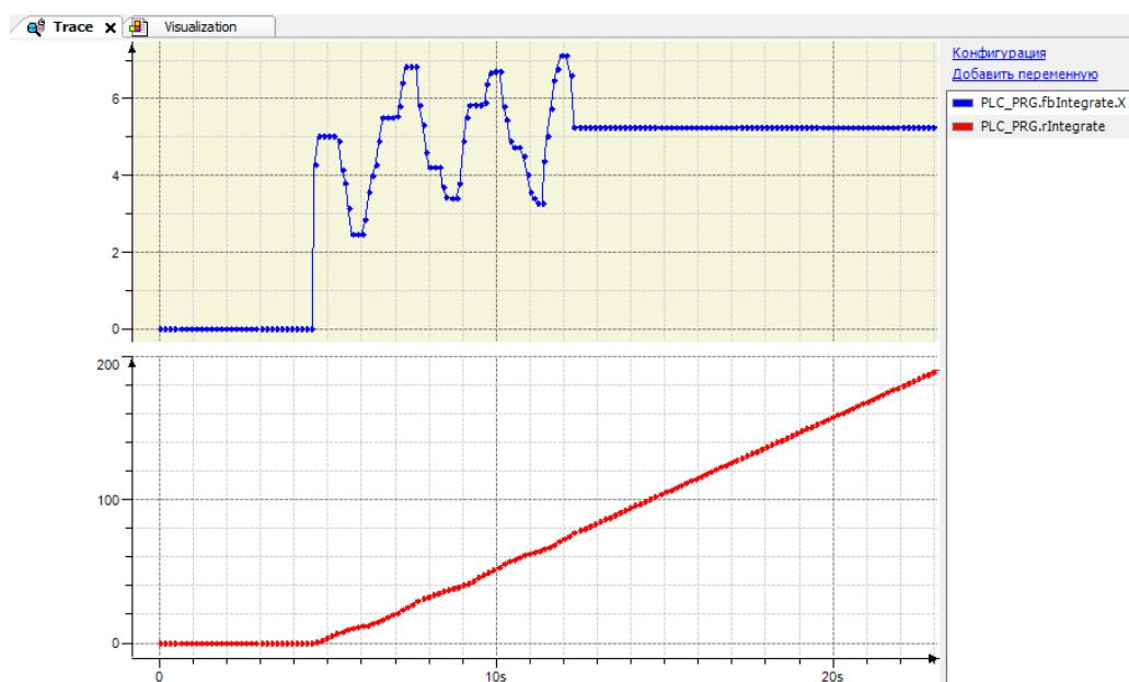
Рис. 23.55. Трассировка работы ФБ INTEGRATE ( $K=2.0$ )
