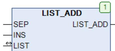
Рис. 26.1. Внешний вид функции LIST\_ADD на языке CFC
