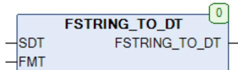
Рис. 13.65. Внешний вид функции **FSTRING\_TO\_DT** на языке CFC
