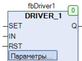
Рис. 24.1. Внешний вид ФБ **DRIVER\_1** на языке CFC
