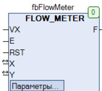
Рис. 21.7. Внешний вид ФБ **FLOW\_METER** на языке CFC
