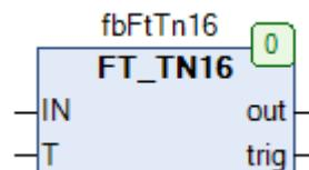
Рис. 23.41. Внешний вид ФБ FT\_TN16 на языке CFC
