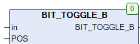
Рис. 16.19. Внешний вид функции BIT\_TOGGLE\_B на языке CFC
