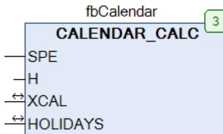
Рис. 12.1. Внешний вид ФБ CALENDAR\_CALC на языке CFC
