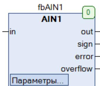
Рис. 19.3. Внешний вид ФБ AIN1 на языке CFC
