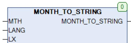
Рис. 13.117. Внешний вид функции **MONTH\_TO\_STRING** на языке CFC
