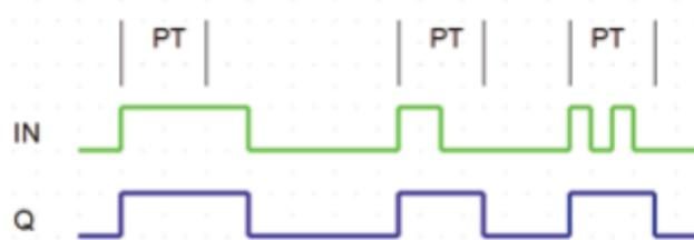
Рис. 15.35. Трассировка работы ФБ TMIN
