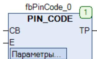
Рис. 16.64. Внешний вид ФБ PIN\_CODE на языке CFC
