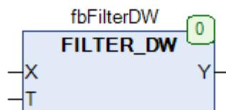
Рис. 19.17. Внешний вид ФБ FILTER\_DW на языке CFC
