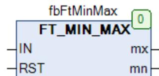
Рис. 9.16. Внешний вид ФБ **FT\_MIN\_MAX** на языке CFC
