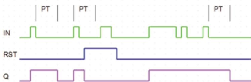
Рис. 15.37. Трассировка работы ФБ **TOF\_1**
