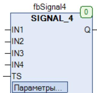
Рис. 24.22. Внешний вид ФБ **SIGNAL\_4** на языке СFC
