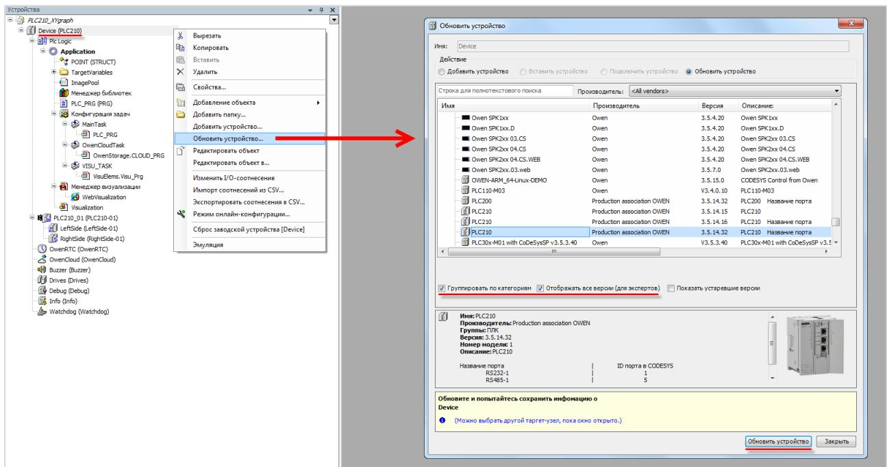
Рисунок 3.1 – Обновление таргет-файла в проекте CODESYS
