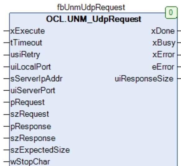
Рисунок 5.2 – Внешний вид ФБ UNM\_UdpRequest на языке CFC
