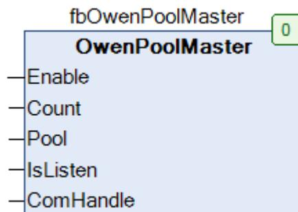
Рисунок 3.12 – Внешний вид ФБ OwenPoolMaster на языке CFC
