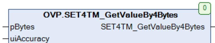
Рисунок 2.5.3 – Внешний вид функции **SET4TM\_GetValueBy4Bytes** на языке CFC
