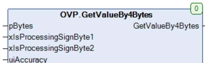
Рисунок 2.5.3 – Внешний вид функции GetValueBy4Bytes на языке CFC
