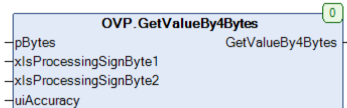
Рисунок 2.5.3 – Внешний вид функции GetValueBy4Bytes на языке CFC
