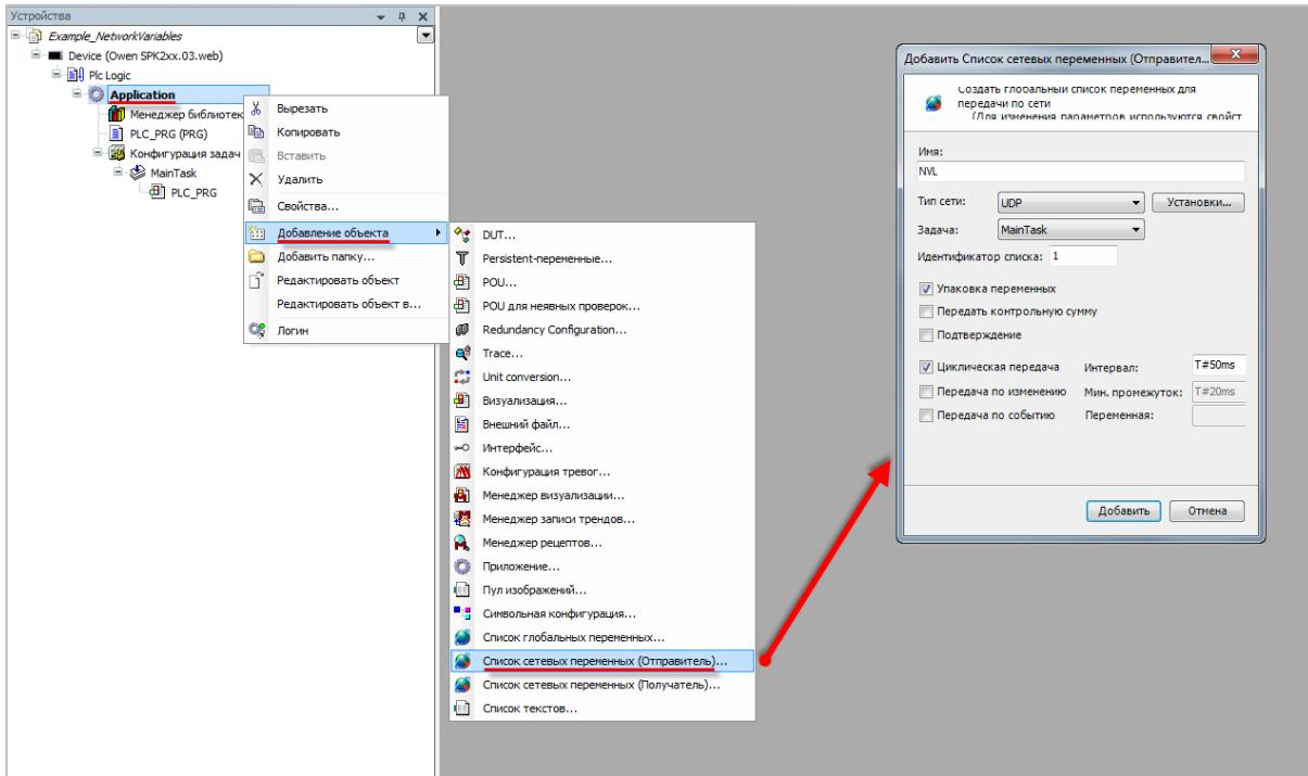
Рисунок 3.2 – Добавление компонента Список сетевых переменных (отправитель)
