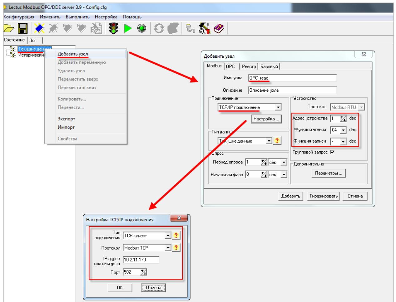
Рисунок 4.4.1 – Добавление узла OPC\_read
