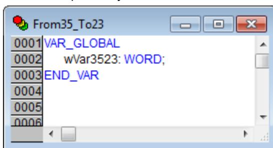
Рисунок 3.11 – Объявление получаемых сетевых переменных для ПЛК110 [M02]
