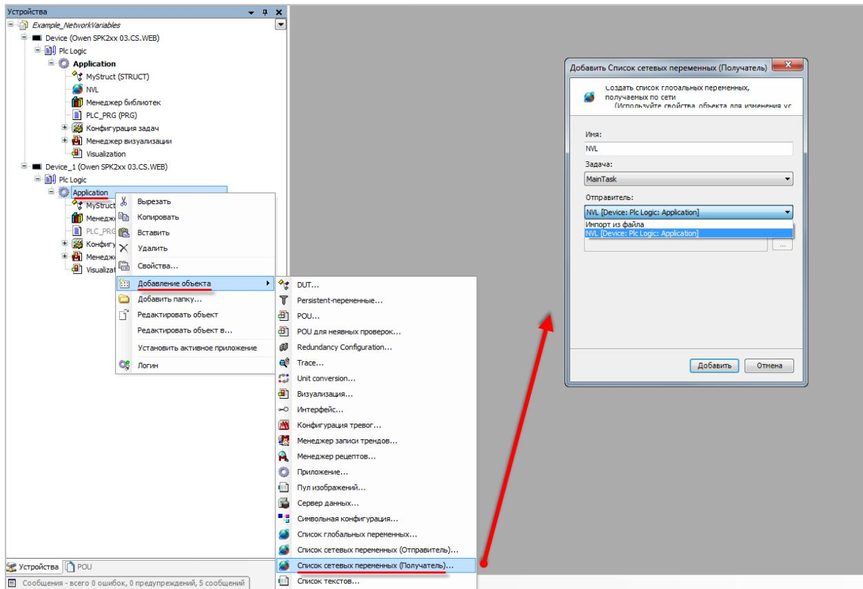
Рисунок 3.8 – Добавление компонента Список сетевых переменных (получатель)
