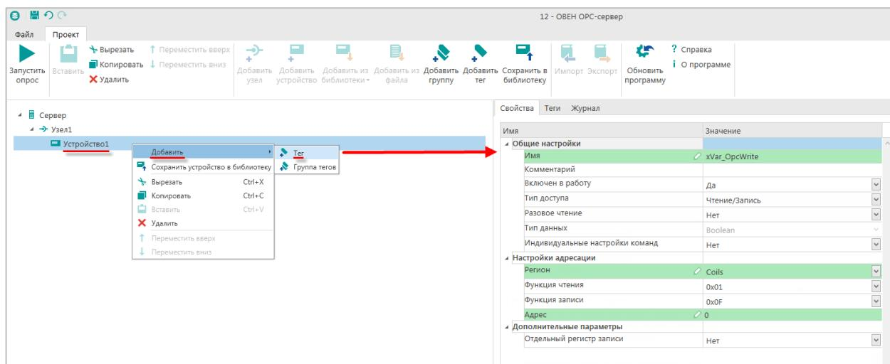
Рисунок 4.5.3 – Добавление и настройка тега xVar\_OpcWrite
