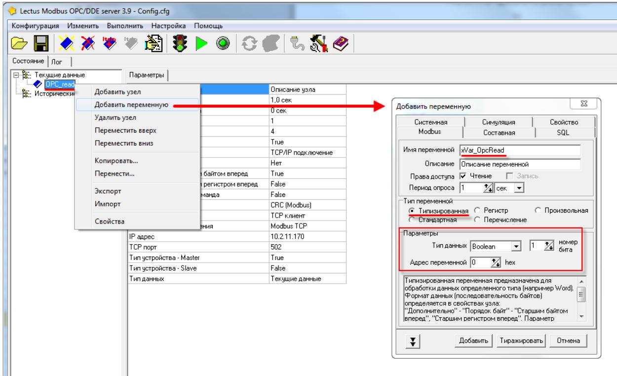
Рисунок 4.4.2 – Добавление и настройка переменной xVar\_OpcRead
