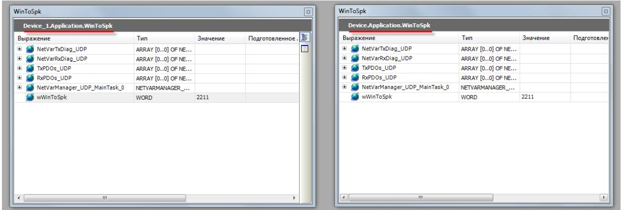
**Рисунок 3.32 – Передача сетевых переменных из виртуального контроллера в контроллер ОВЕН**
