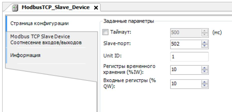
**Рисунок 4.3.7 – Настройки компонента Modbus TCP Slave Device**
