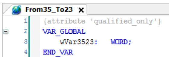
Рисунок 3.15 – Объявление отправляемых сетевых переменных для СПК1xx [M01]
