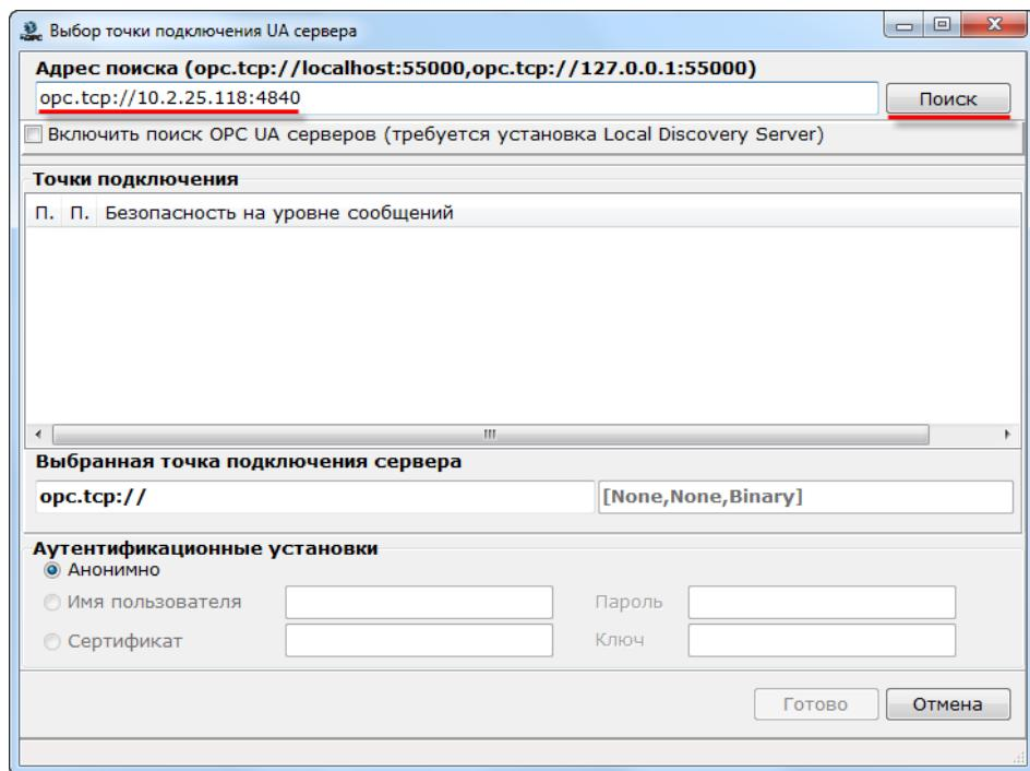
Рисунок 4.6.4 – Указание сетевых настроек OPC UA сервера
