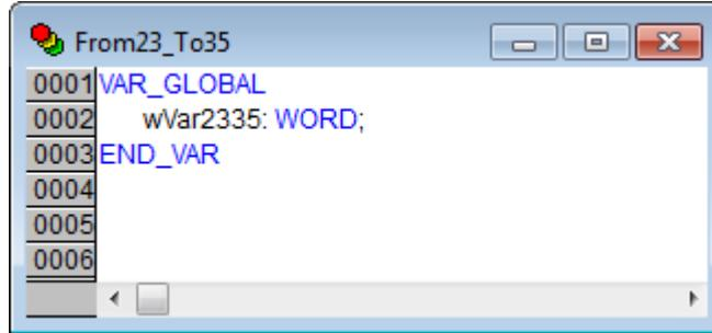
Рисунок 3.13 – Объявление отправляемых сетевых переменных для ПЛК110 [M02]
