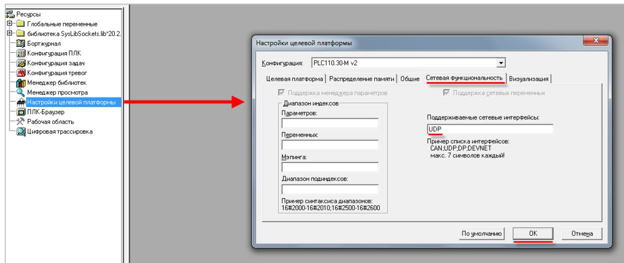
**Рисунок 3.9 – Включение поддержки сетевых переменных в CoDeSys V2.3**
