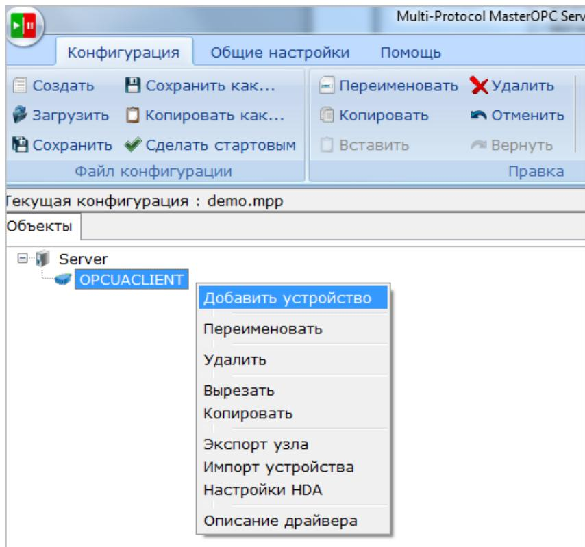
Рисунок 4.6.2 – Добавление устройства
