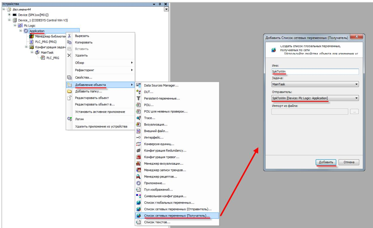
Рисунок 3.25 – Импорт сетевых переменных в устройство **Device\_1**
