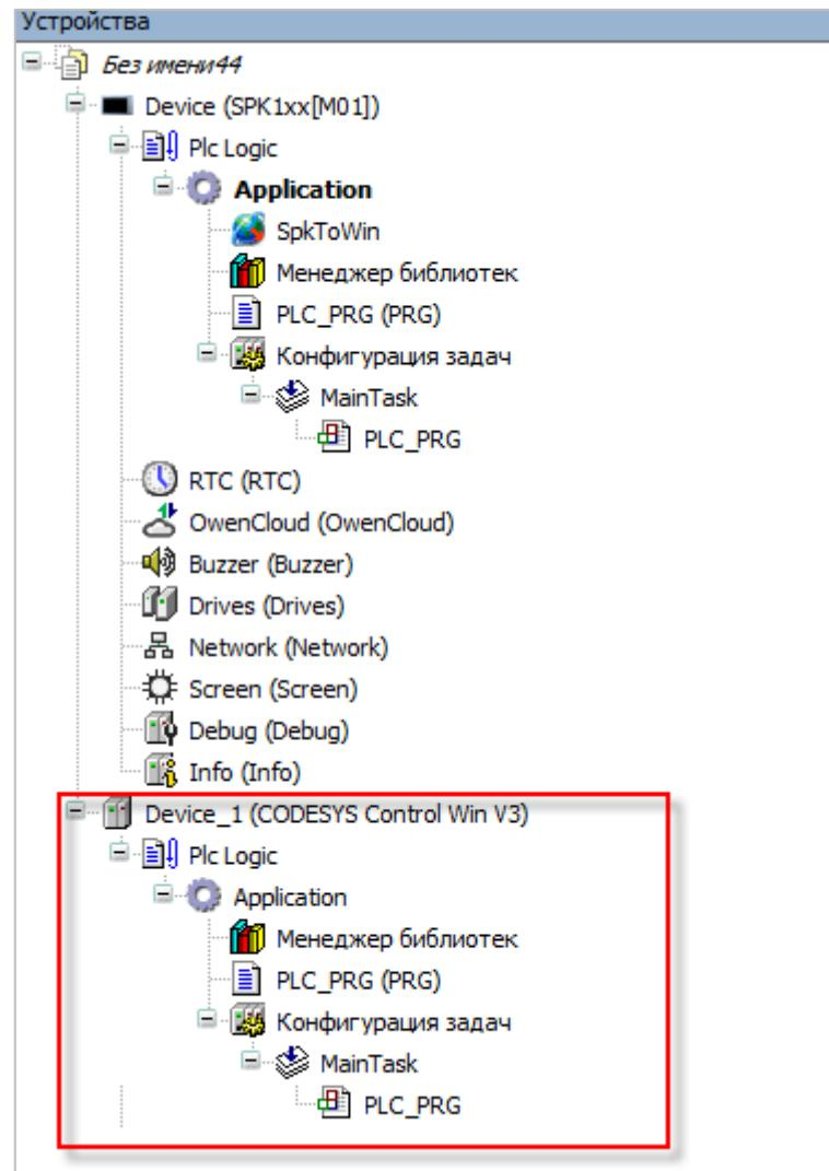
Рисунок 3.24 – Внешний вид устройства Device\_1 в дереве проекта
