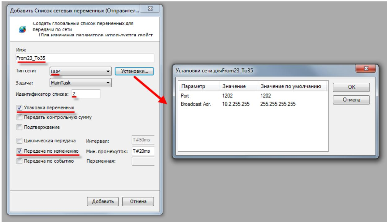
Рисунок 3.14 – Настройки «имитационного» списка отправляемых сетевых переменных
