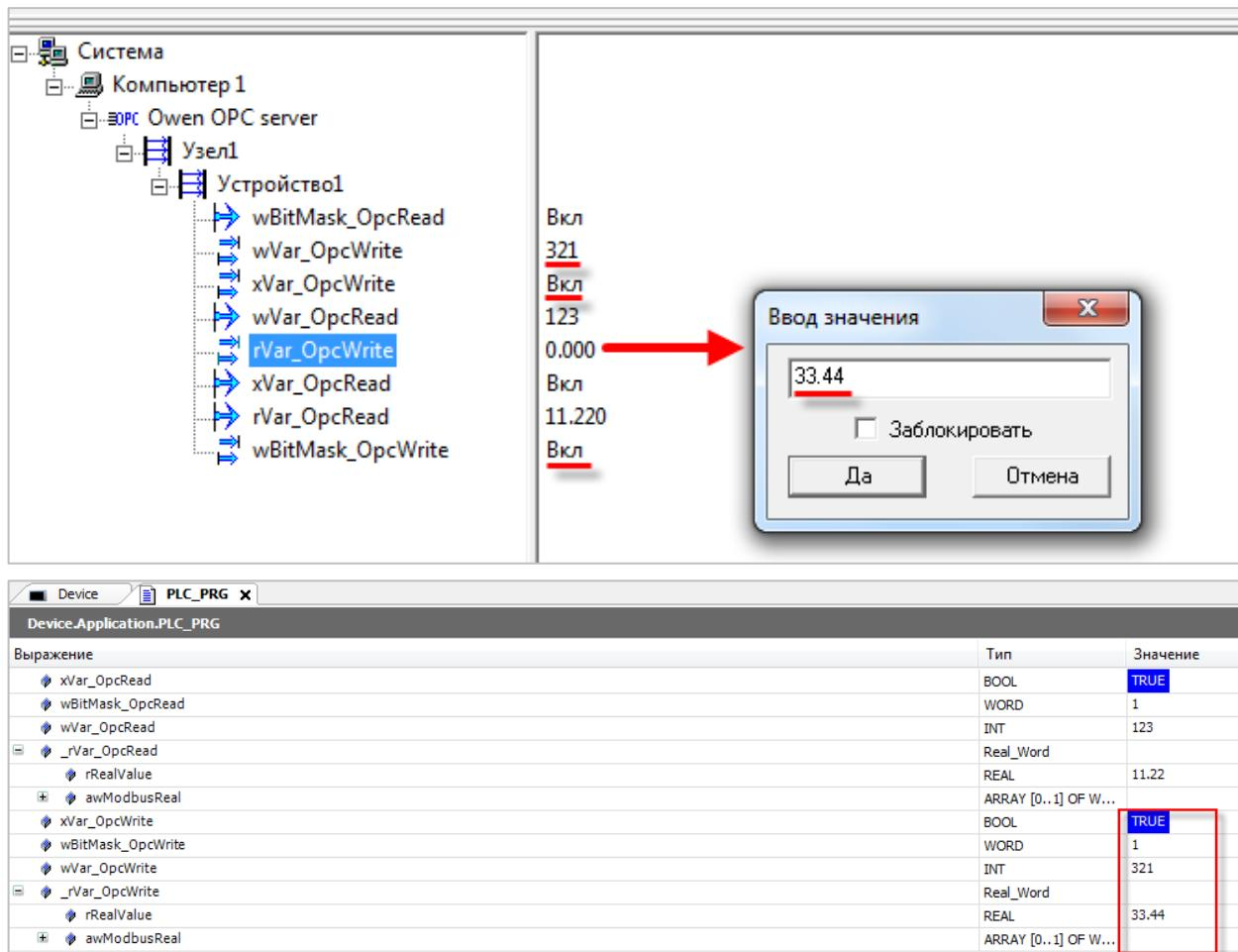
Рисунок 4.7.7 – Запись данных из MasterSCADA в контроллер
