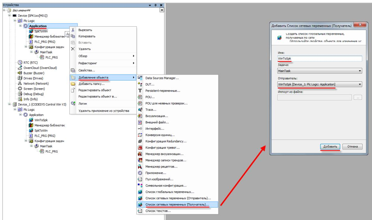
Рисунок 3.28 – Импорт сетевых переменных в устройство Device\_1
