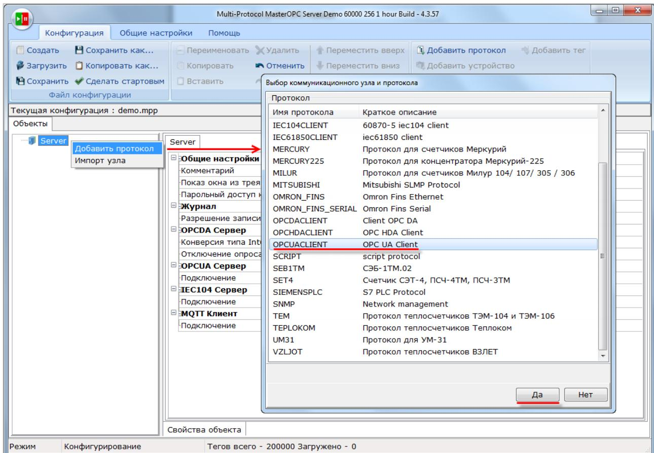
Рисунок 4.6.1 – Добавление протокола
