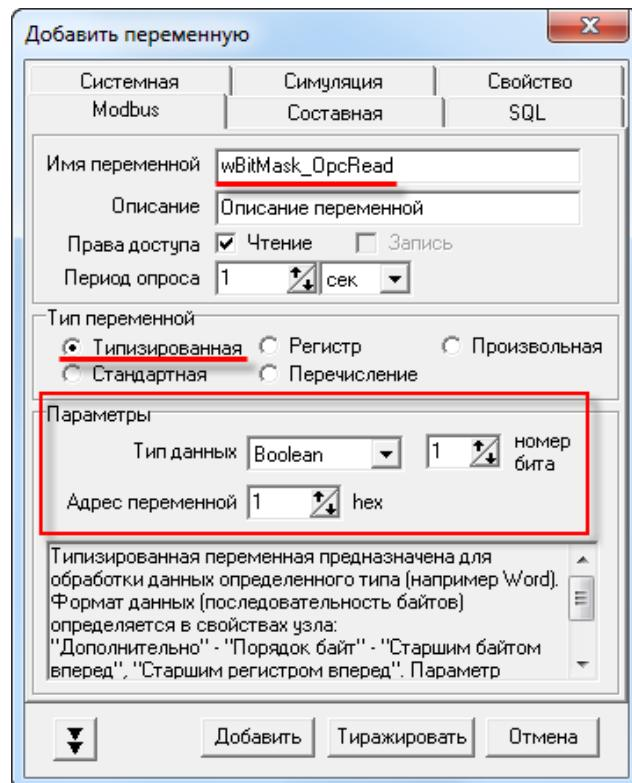
Рисунок 4.4.3 – Добавление и настройка переменной wBitMask\_OpcRead
