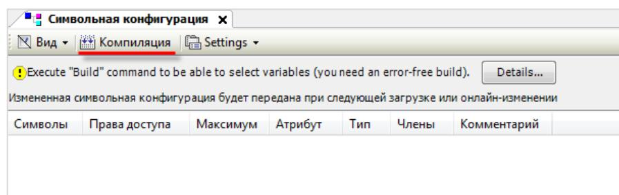
Рисунок 4.2.3 – Кнопка компиляции проекта после создания символьной конфигурации
