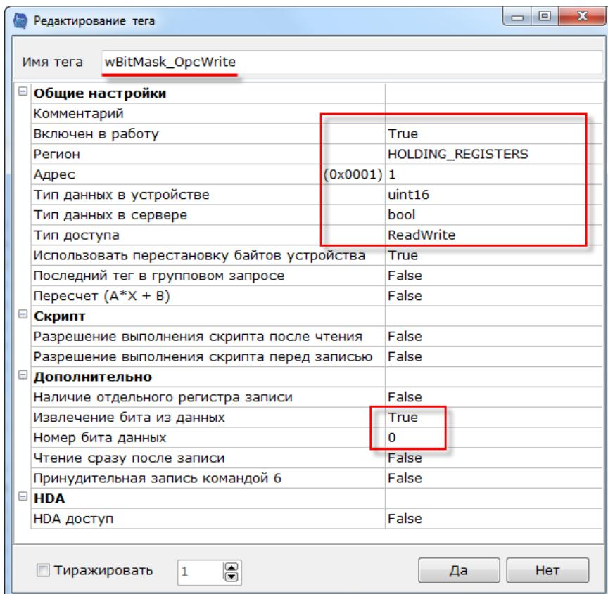
Рисунок 4.3.12 – Настройки тега wBitMask\_OpcWrite
