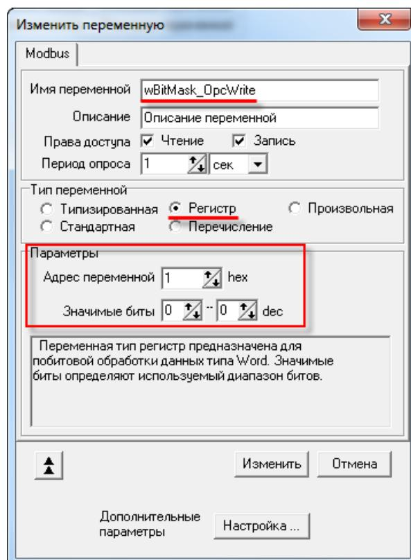
Рисунок 4.4.8 – Настройки переменной **wBitMask\_OpcWrite**
