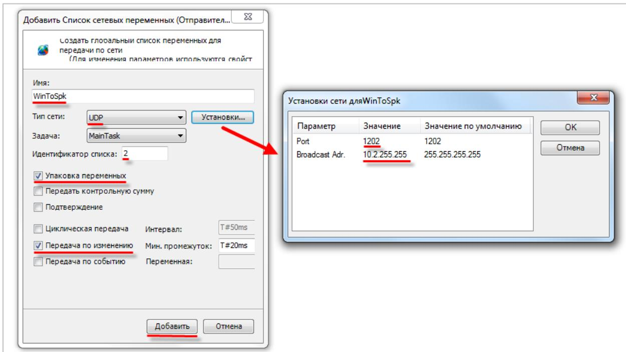
Рисунок 3.26 – Настройки списка отправляемых сетевых переменных для СПК1xx [M01]
