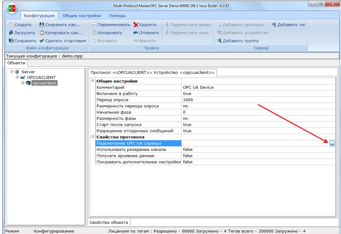
Рисунок 4.6.3 – Запуск подключения к OPC UA серверу
