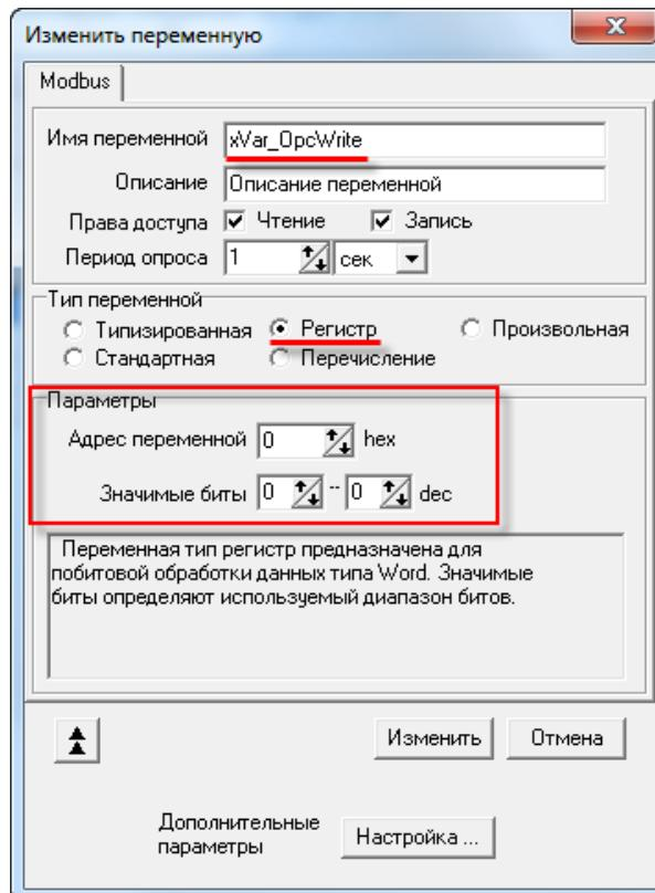
Рисунок 4.4.7 – Добавление и настройки переменной **xVar\_OpcWrite**
