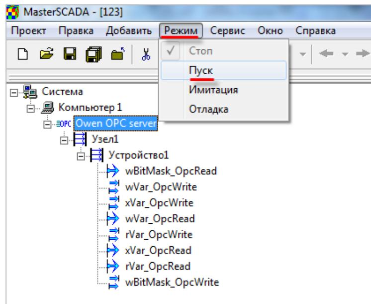
Рисунок 4.7.5 – Запуск проекта MasterSCADA на исполнение
