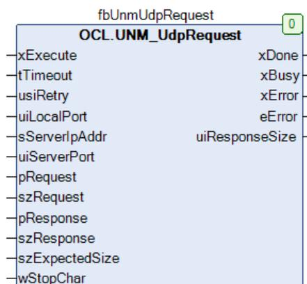
Рисунок 5.7.3 – Внешний вид ФБ UNM\_UdpRequest на языке CFC
