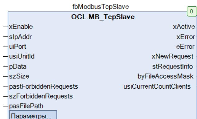
Рисунок 5.6.4 – Внешний вид ФБ MB\_TcpSlave на языке CFC
