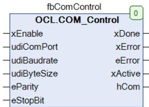
Рисунок 5.5.1 – Внешний вид ФБ COM\_Control на языке CFC
