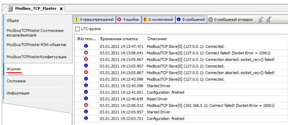
**Рисунок 4.6.10 – Вкладка Журнал в компоненте Modbus TCP Master**
