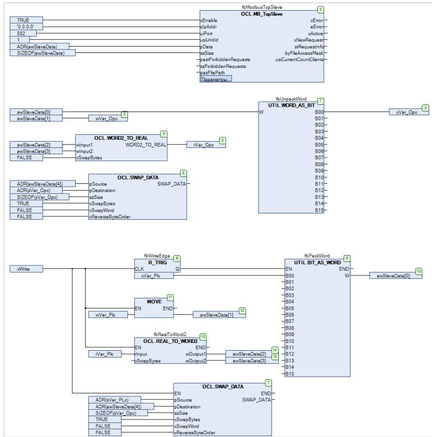
Рисунок 5.9.35 – Код программы на языке CFC
