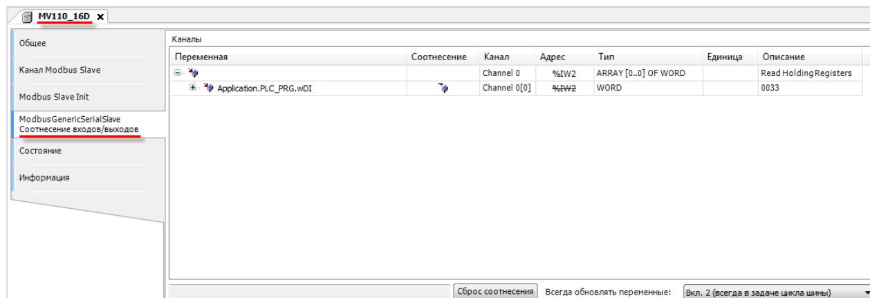
Рисунок 4.9.18 – Привязка переменных к каналу
