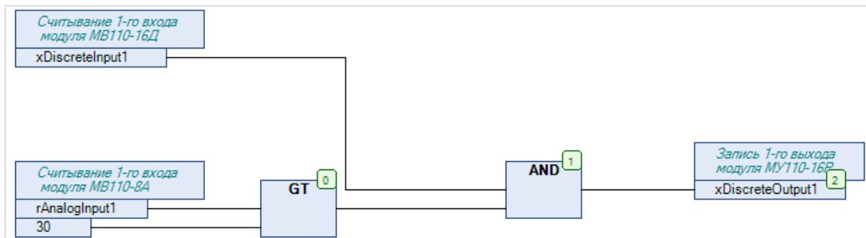
Рисунок 3.2.15 – Код программы на языке CFC
