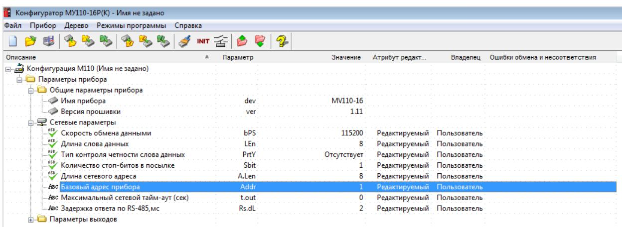
Рисунок 2.4 – Настройка модуля с помощью конфигуратора
