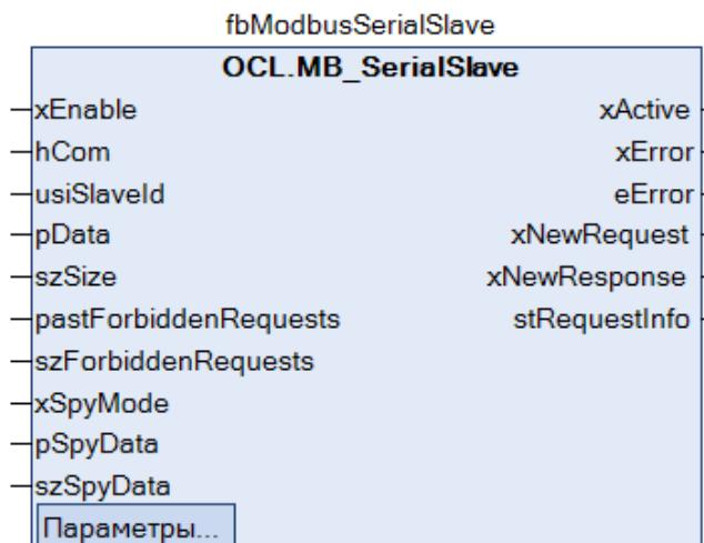
Рисунок 5.6.2 – Внешний вид ФБ MB\_SerialSlave на языке CFC
