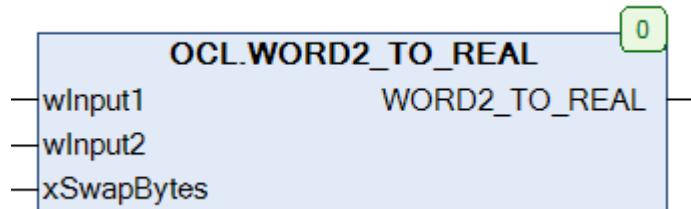
Рисунок 5.8.7 – Внешний вид функции WORD2\_TO\_REAL на языке CFC
