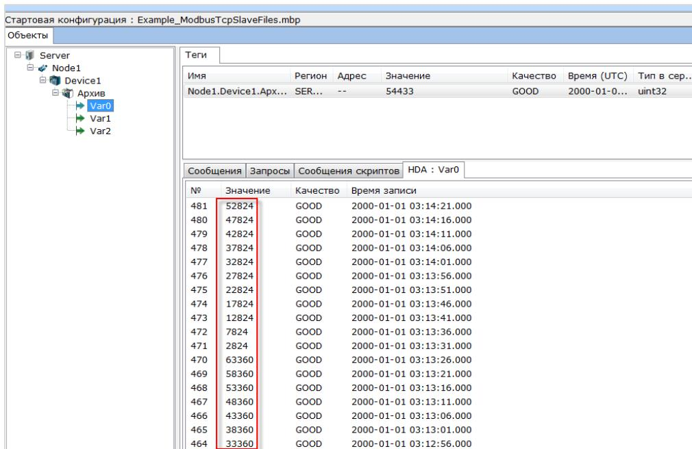
Рисунок 5.9.56 – Считывание архивных данных через OPC-сервер
