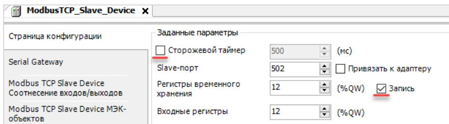
Рисунок 6.5 – Настройки компонента Modbus Serial Device
