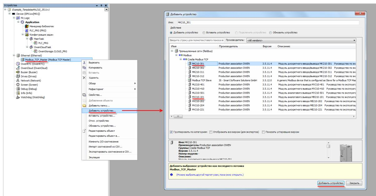
Рисунок 4.11.12 – Добавление slave-устройств в проект CODESYS
