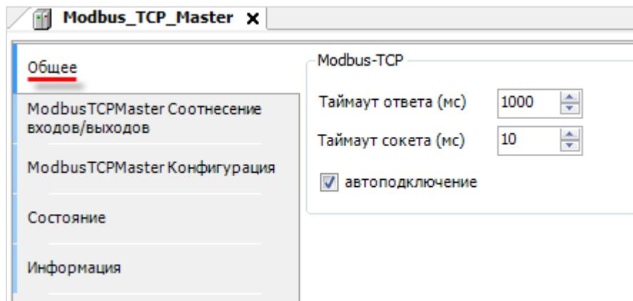
Рисунок 3.3.8 – Настройки компонента Modbus TCP Master
