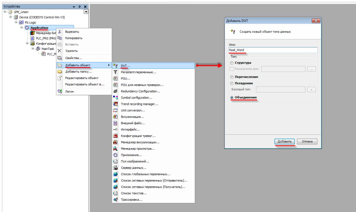
Рисунок 4.10.3 – Добавление в проект объединения Real\_Word
