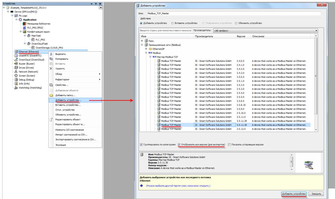
**Рисунок 4.4.4 – Добавление компонента Modbus TCP Master**
