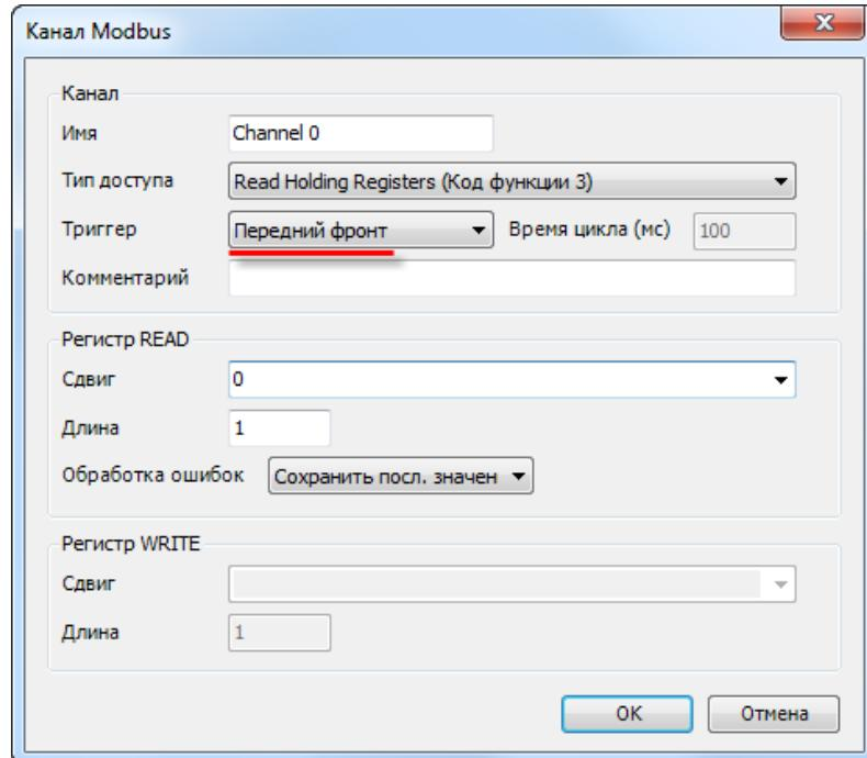
Рисунок 6.3 – Настройка опроса канала по триггеру
