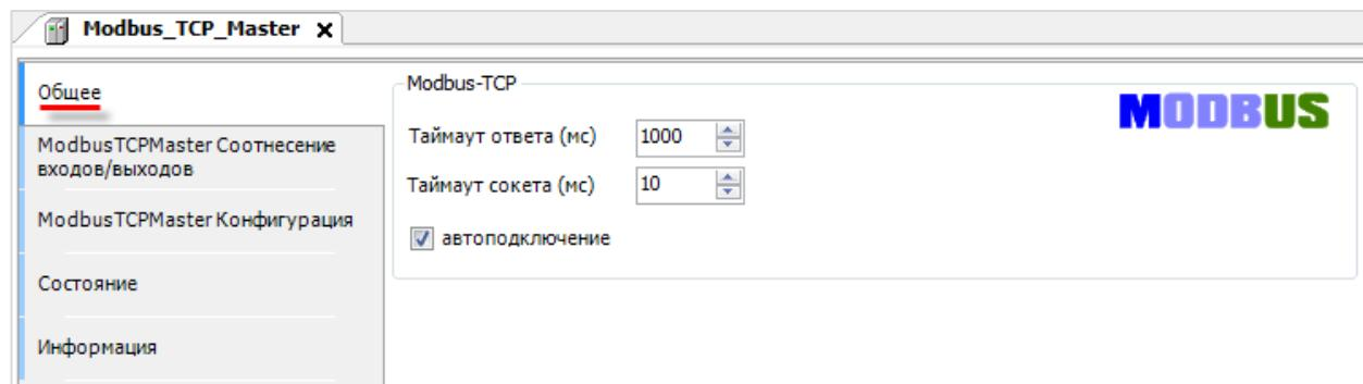
**Рисунок 4.4.5 – Настройки компонента Modbus TCP Master**
