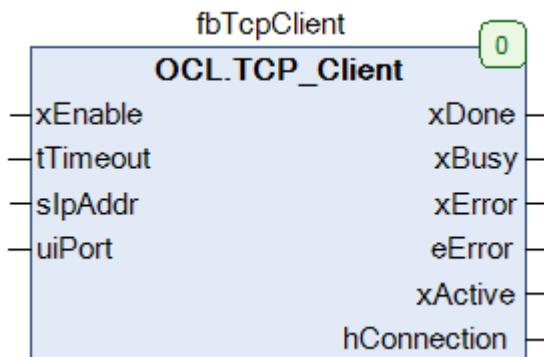
Рисунок 5.5.2 – Внешний вид ФБ TCP\_Client на языке CFC
