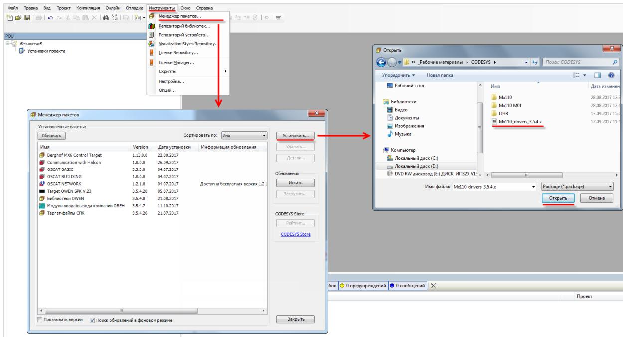
**Рисунок 3.1.1 – Установка пакета шаблонов в среду CODESYS**
