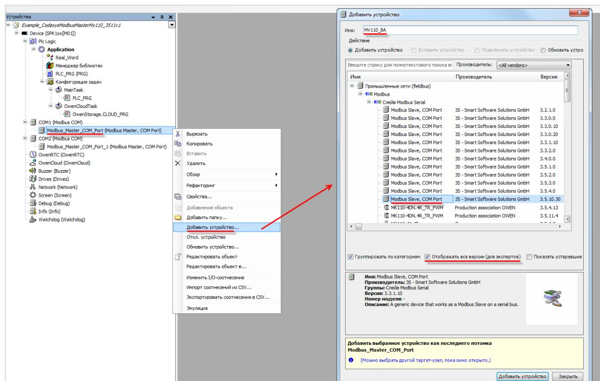
Рисунок 4.9.12 – Добавление slave-устройств в проект CODESYS
