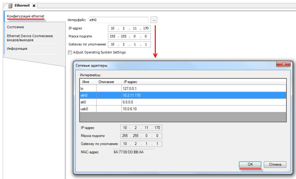
Рисунок 4.4.3 – Выбор используемого интерфейса
