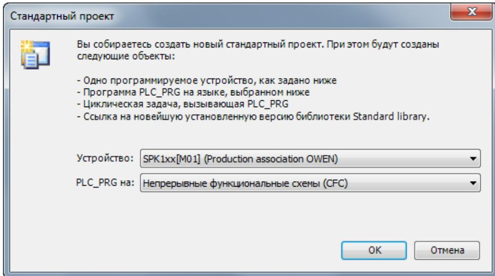
Рисунок 4.9.2 – Создание проекта CODESYS
