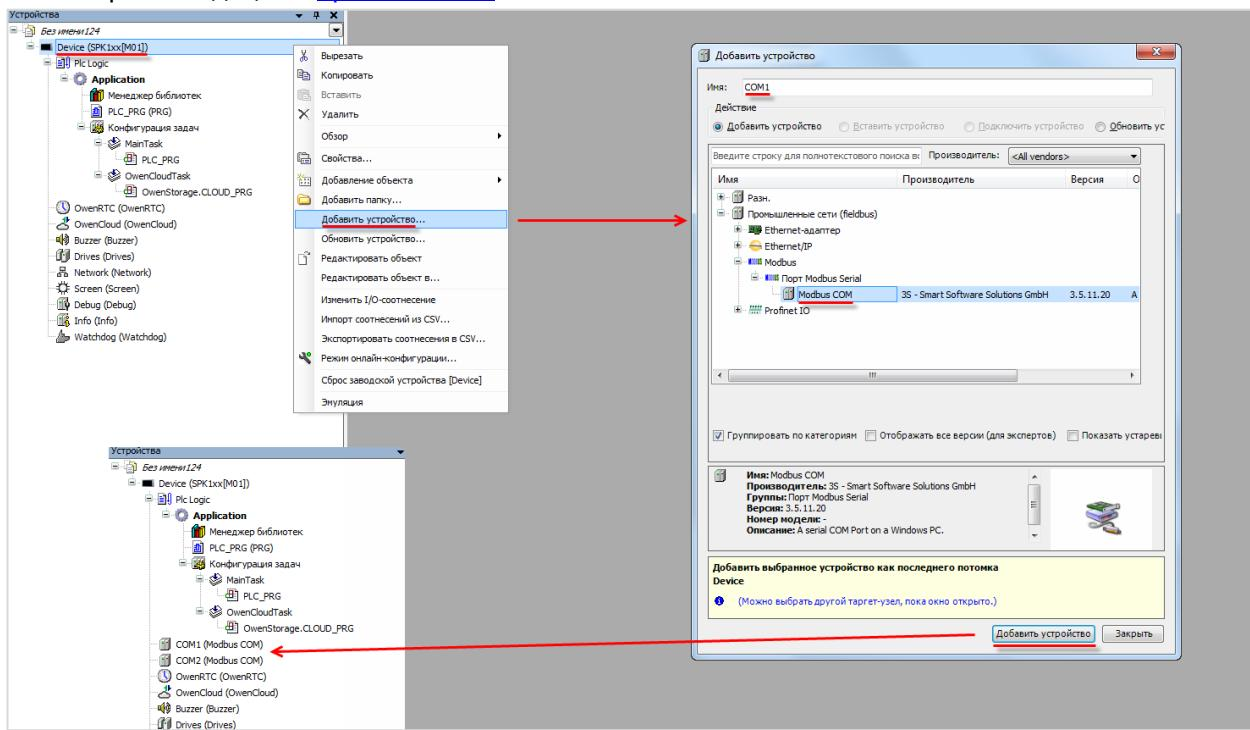
Рисунок 4.9.7 – Добавление компонента Modbus COM
