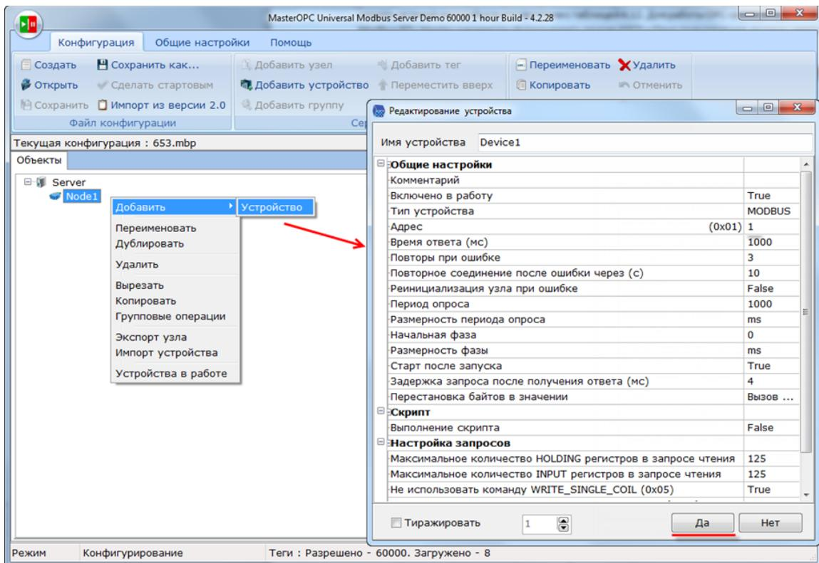
Рисунок 5.9.38 – Добавление устройства
