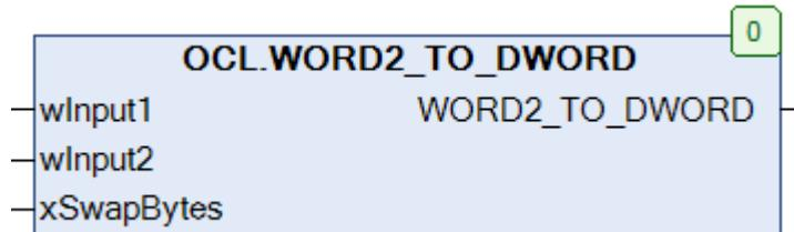
Рисунок 5.8.5 – Внешний вид функции WORD2\_TO\_DWORD на языке CFC
