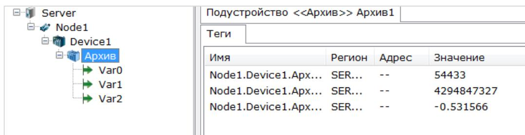
Рисунок 5.9.55 – Считывание и запись данных через OPC-сервер
