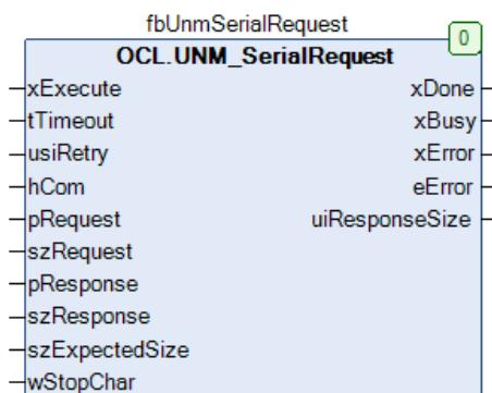
Рисунок 5.7.1 – Внешний вид ФБ UNM\_SerialRequest на языке CFC
