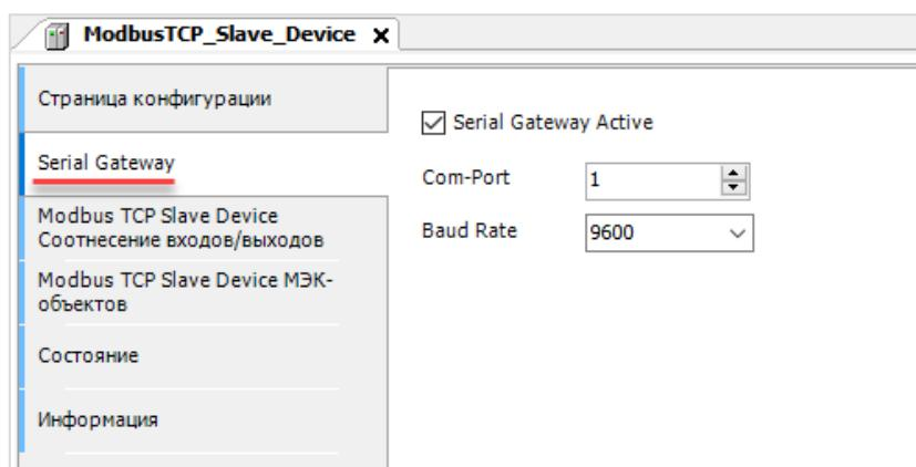
**Рисунок 4.13.1 – Настройка шлюза Modbus TCP/Modbus RTU в компоненте Modbus TCP Slave Device**
