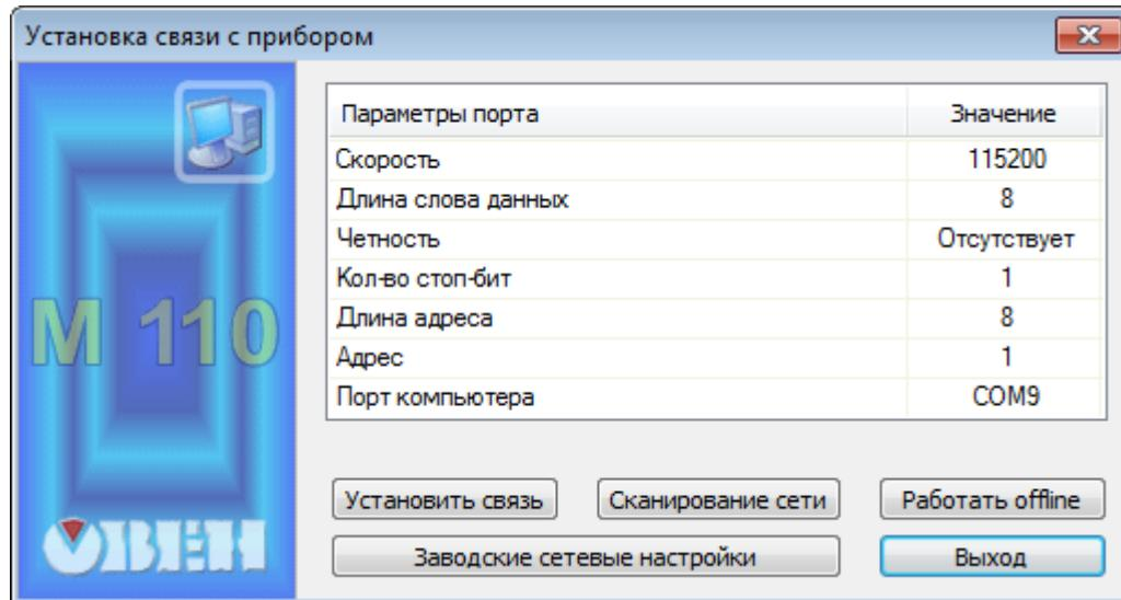
Рисунок 2.3 – Подключение к модулю Mx110 с помощью программы Конфигуратор Mx110
