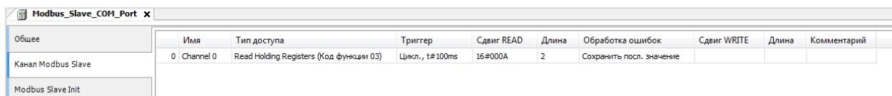
Рисунок 4.8.12 – Настройка канала для считывания значения с плавающей точкой
