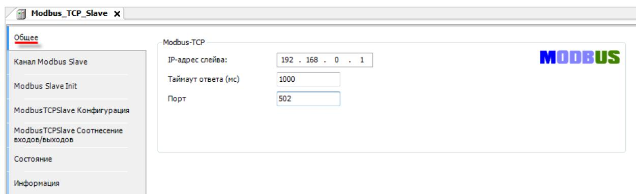
Рисунок 4.4.7 – Настройки компонента Modbus TCP Slave, вкладка Общее
