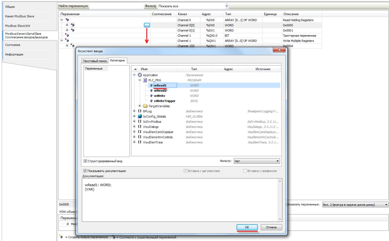
Рисунок 4.2.11 – Привязка переменных программы к каналам Modbus Slave
