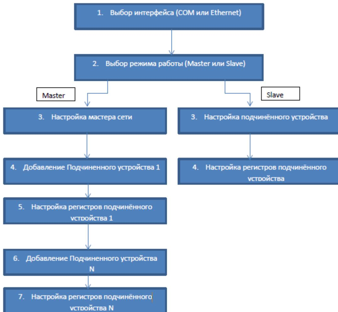
Рисунок 4.1.1 – Последовательность конфигурирования Modbus в CODESYS
