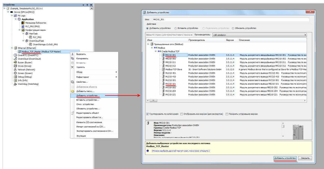
Рисунок 3.3.9 – Добавление шаблонов модулей в проект CODESYS
