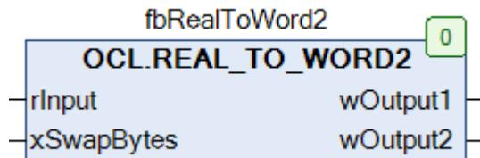
Рисунок 5.8.3 – Внешний вид ФБ REAL\_TO\_WORD2 на языке CFC
