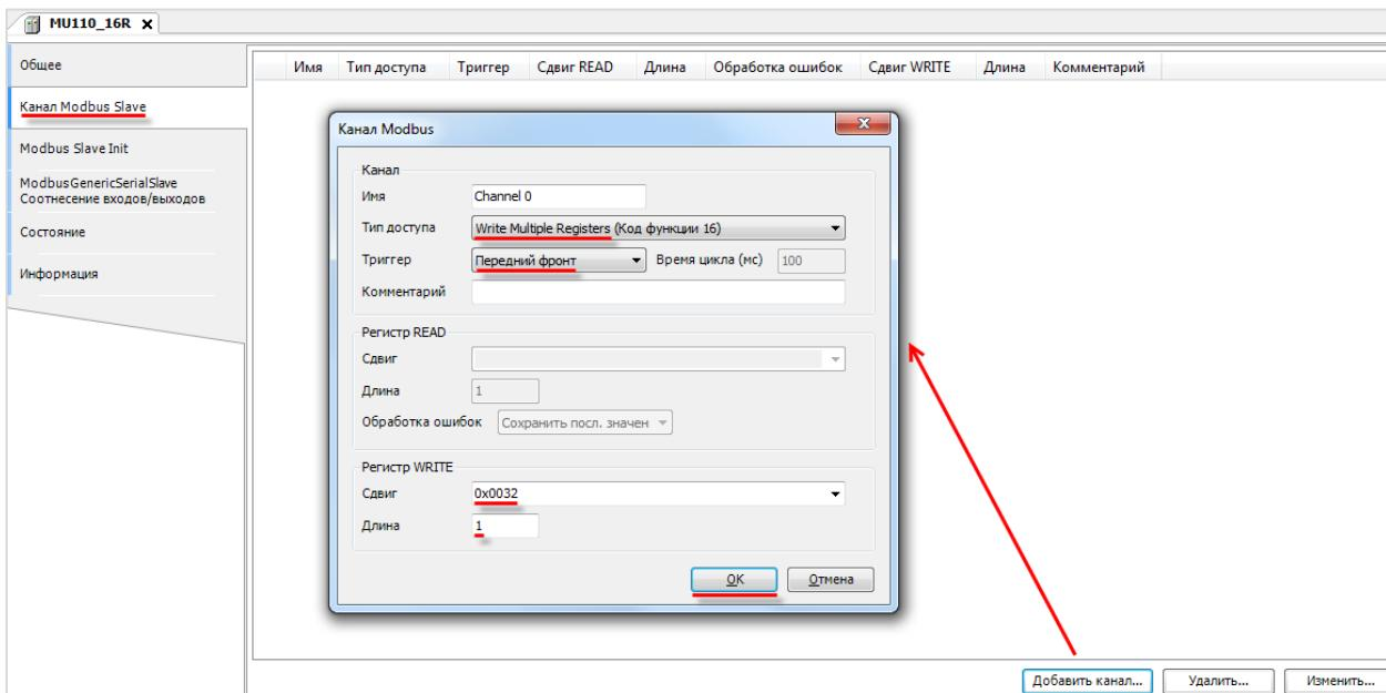
Рисунок 4.9.19 – Добавление канала в конфигурацию slave-устройства MU110\_16R
