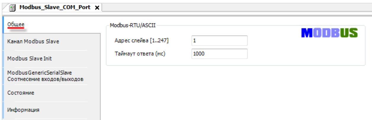
Рисунок 4.2.6 – Настройки компонента Modbus Slave, вкладка Общее
