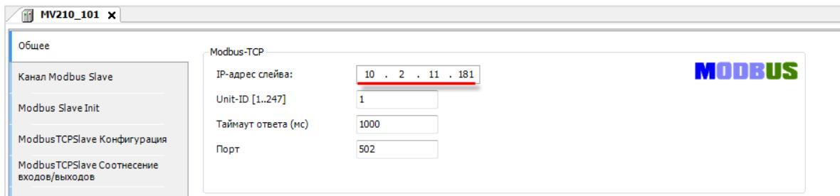
Рисунок 4.11.13 – Настройки компонента Modbus TCP Slave, вкладка Общее
