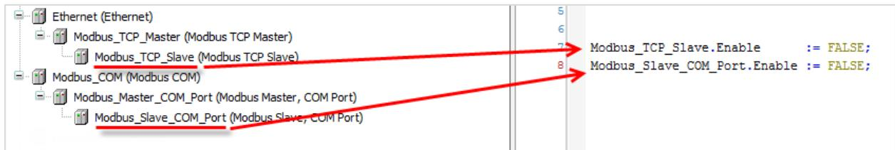
Рисунок 4.6.4 – Исключение slave-устройств из опроса
