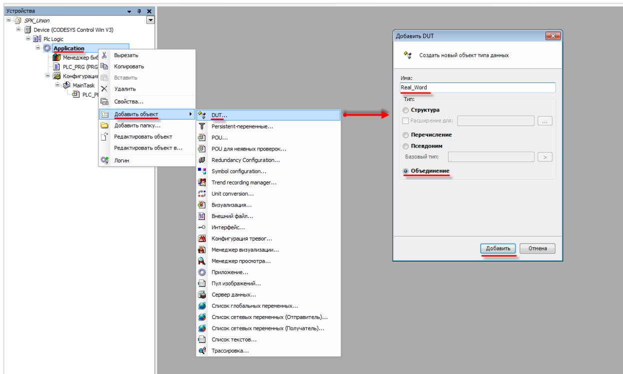
Рисунок 4.12.3 – Добавление в проект объединения Real\_Word
