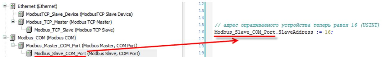
Рисунок 4.6.5 – Изменение заданного адреса опрашиваемого slave-устройства
