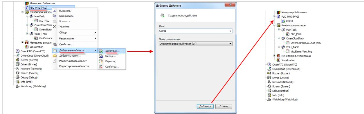
Рисунок 6.6 – Добавление действия в проект CODESYS
