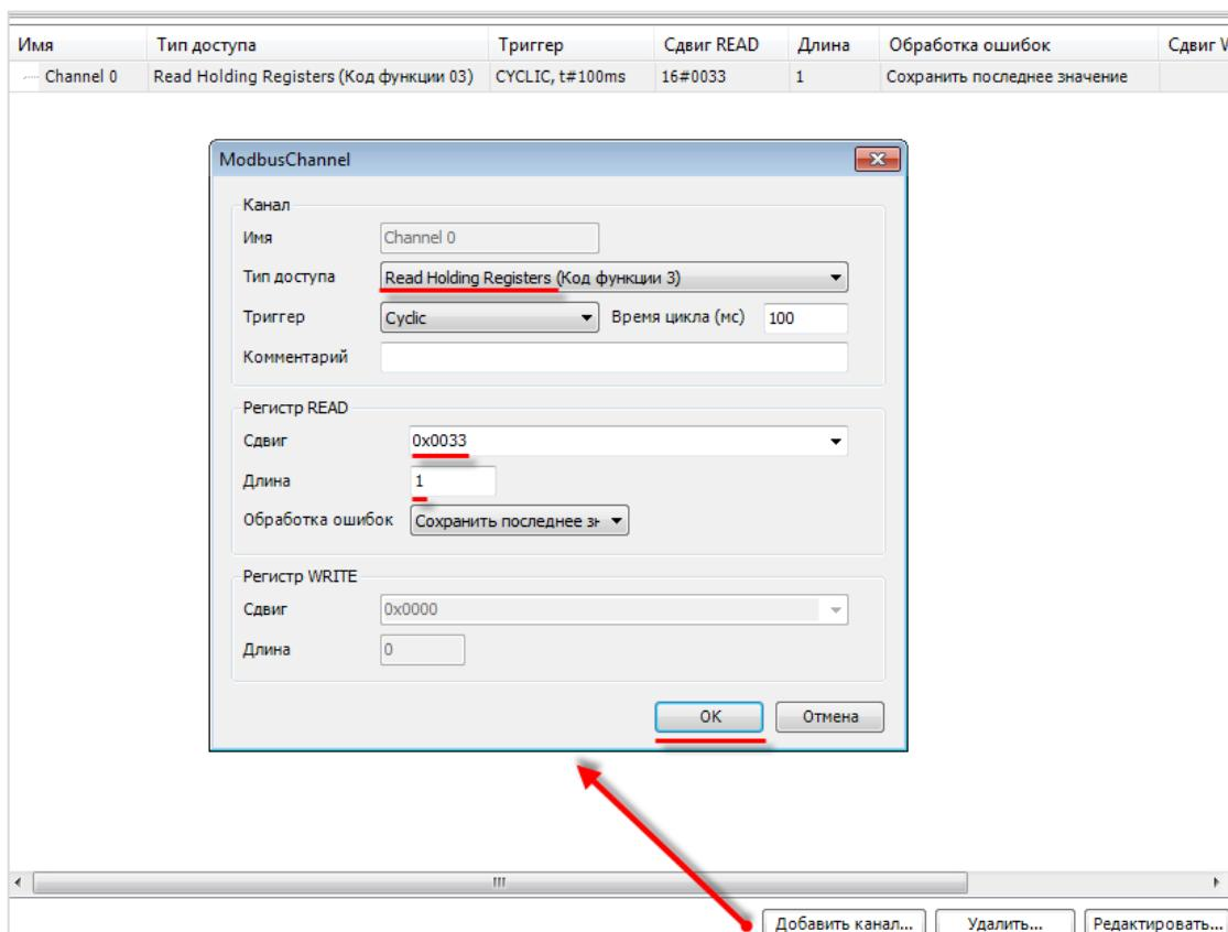
Рисунок 4.9.17 – Добавление канала в конфигурацию slave-устройства MV110\_16D
