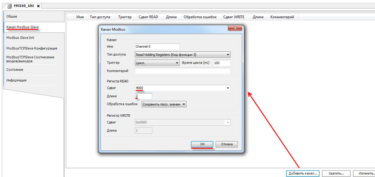
Рисунок 4.11.15 – Добавление канала в конфигурацию slave-устройства MV210\_101
