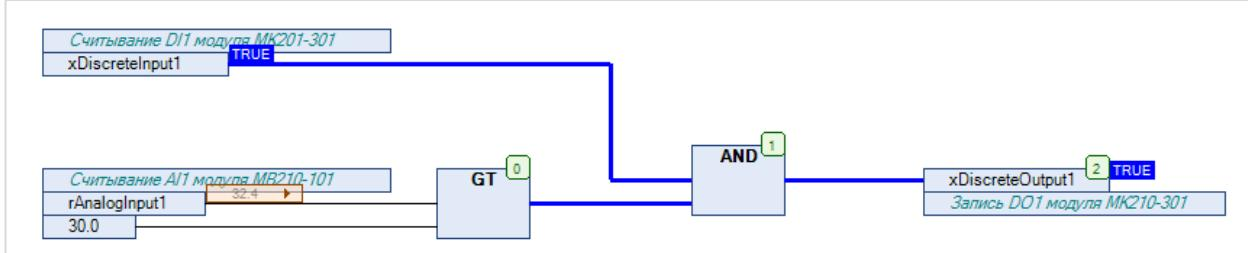
Рисунок 3.3.13 – Код программы на языке CFC
