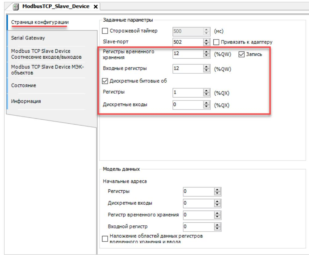
**Рисунок 4.12.8 – Настройки компонента Modbus TCP Slave Device**
