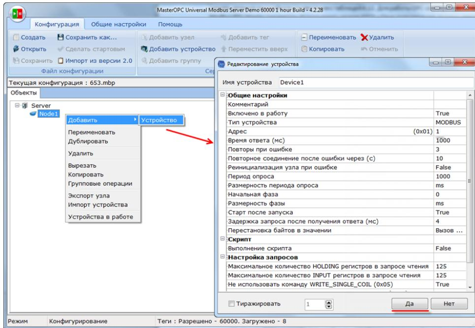
**Рисунок 5.9.50 – Добавление устройства**
