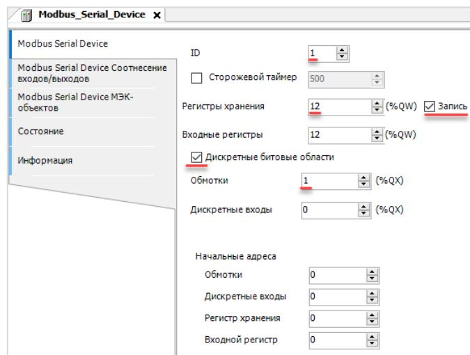
Рисунок 4.10.9 – Настройки компонента Modbus Serial Device
