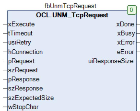
Рисунок 5.7.2 – Внешний вид ФБ UNM\_TcpRequest на языке CFC
