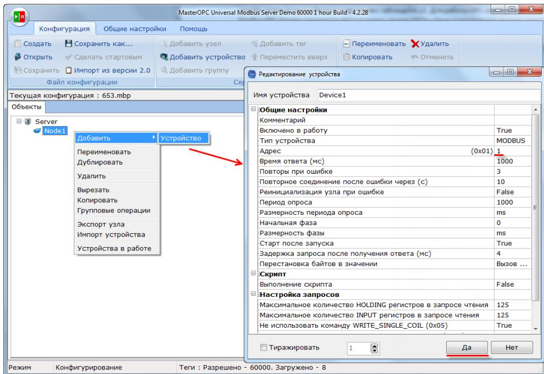
Рисунок 4.10.12 – Добавление устройства
