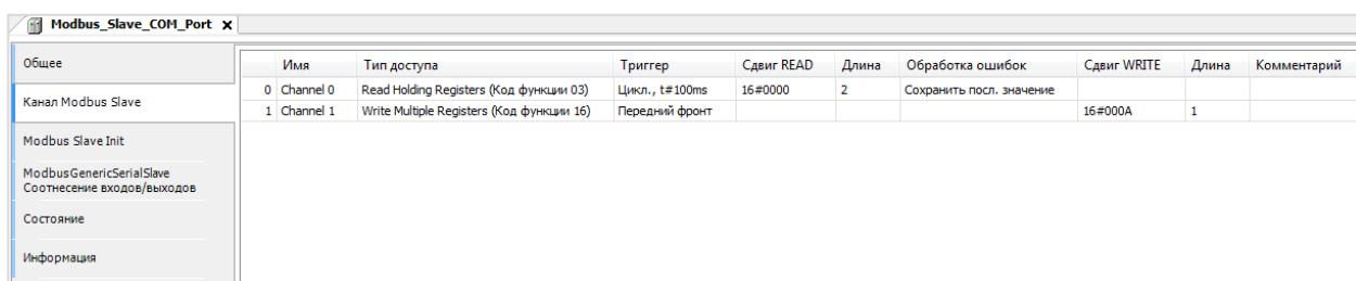
**Рисунок 4.2.8 – Пример настройки каналов Modbus Slave**
