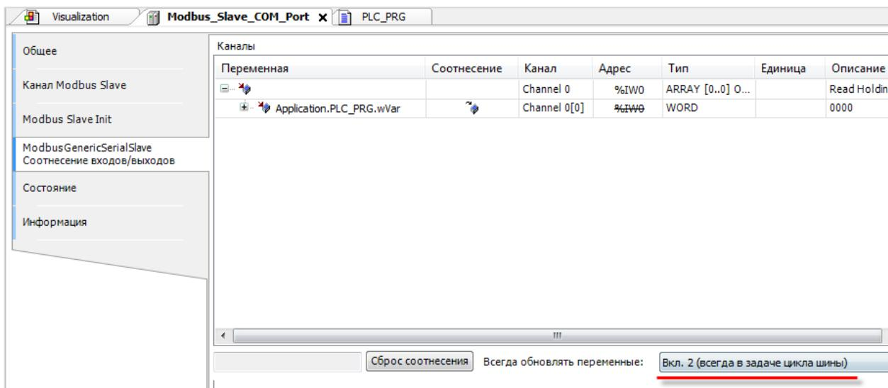
**Рисунок 6.1 – Настройка параметра Всегда обновлять переменные**
