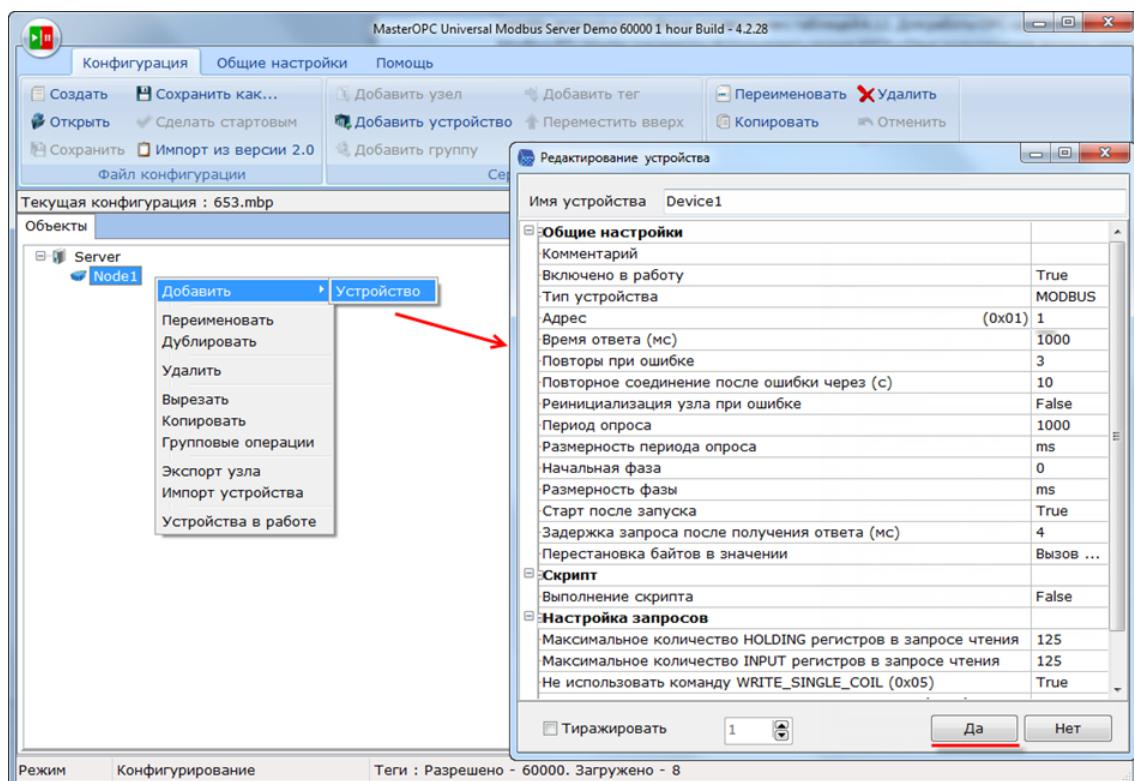
Рисунок 4.12.11 – Добавление устройства
