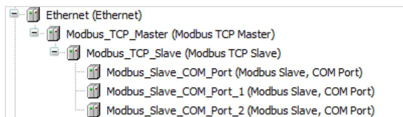
**Рисунок 4.13.2 – Настройка соединения со шлюзом Modbus TCP/Modbus RTU**
