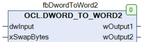
Рисунок 5.8.1 – Внешний вид ФБ DWORD\_TO\_WORD2 на языке CFC
