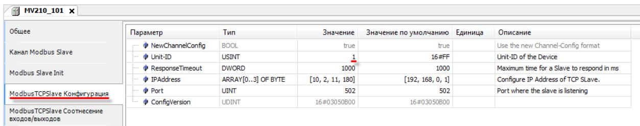
Рисунок 4.11.14 – Настройки компонента Modbus TCP Slave, вкладка Modbus TCP Slave Конфигурация
