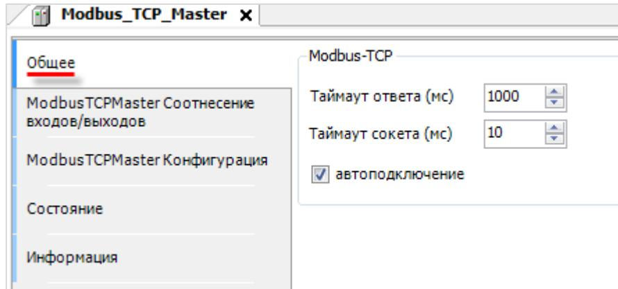
Рисунок 4.11.11 – Настройки компонента Modbus TCP Master
