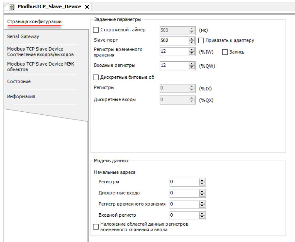
**Рисунок 4.5.3 – Настройки компонента Modbus TCP Slave Device**
