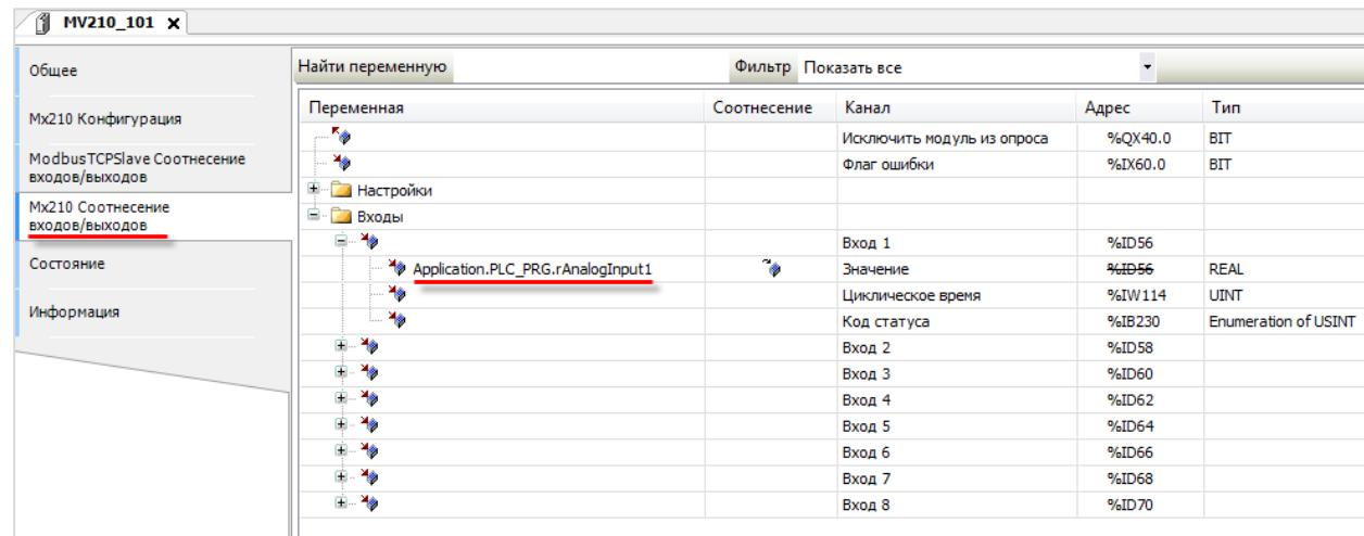
Рисунок 3.3.11 – Привязка переменной к шаблону модуля MB210-101
