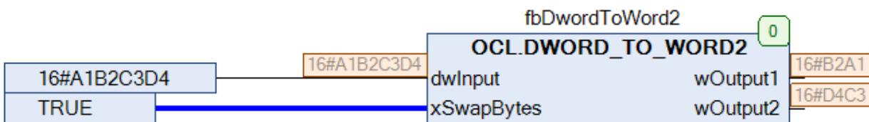
Рисунок 5.8.2 – Пример использования ФБ DWORD\_TO\_WORD2 на языке CFC
