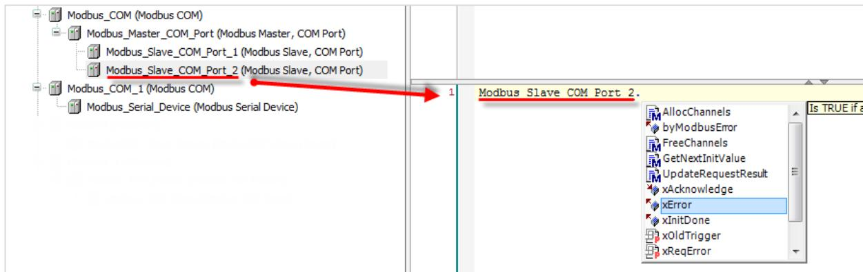
Рисунок 4.6.1 – Использование переменных диагностики в программе
