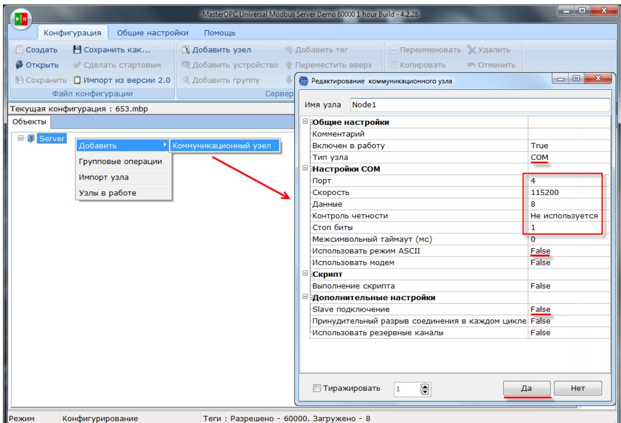
Рисунок 4.10.11 – Добавление коммуникационного узла
