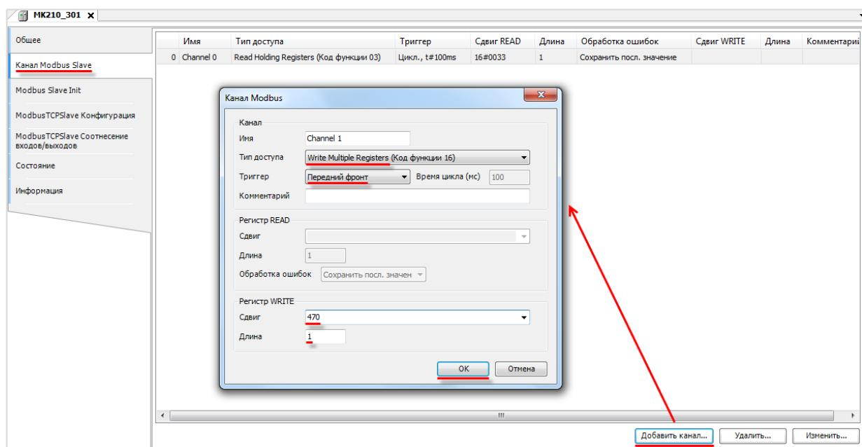
Рисунок 4.11.17 – Добавление каналов в конфигурацию slave-устройства MK210\_301
