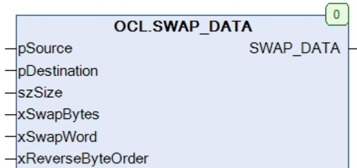
Рисунок 5.8.9 – Внешний вид функции SWAP\_DATA на языке CFC
