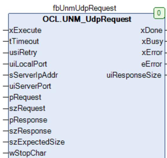
Рисунок 5.7.3 – Внешний вид ФБ UNM\_UdpRequest на языке CFC
