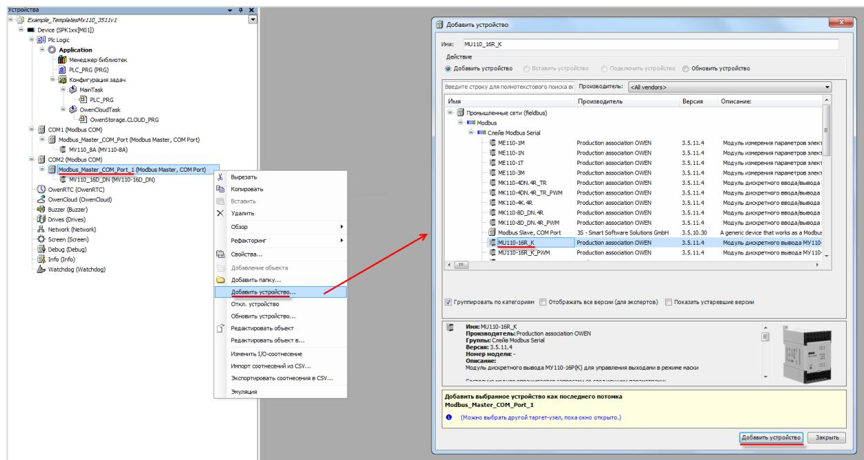
Рисунок 3.2.9 – Добавление шаблонов модулей в проект CODESYS
