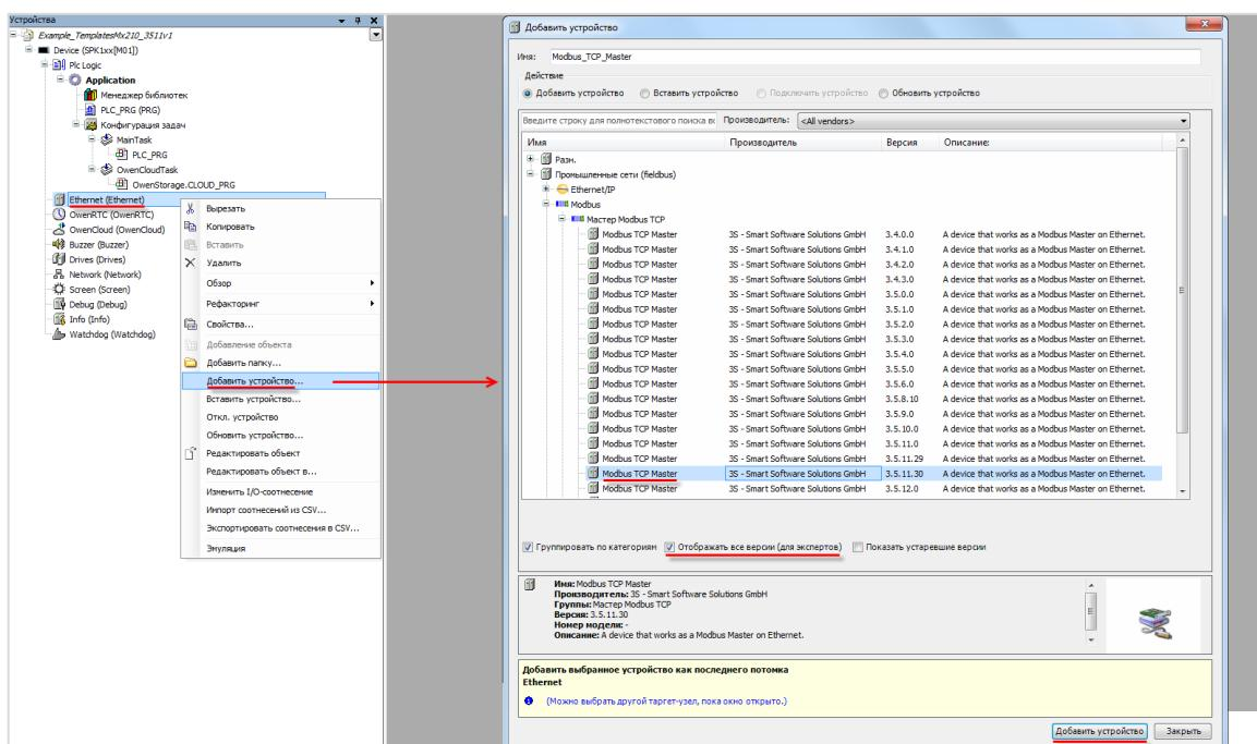
Рисунок 3.3.7 – Добавление компонента Modbus TCP Master
