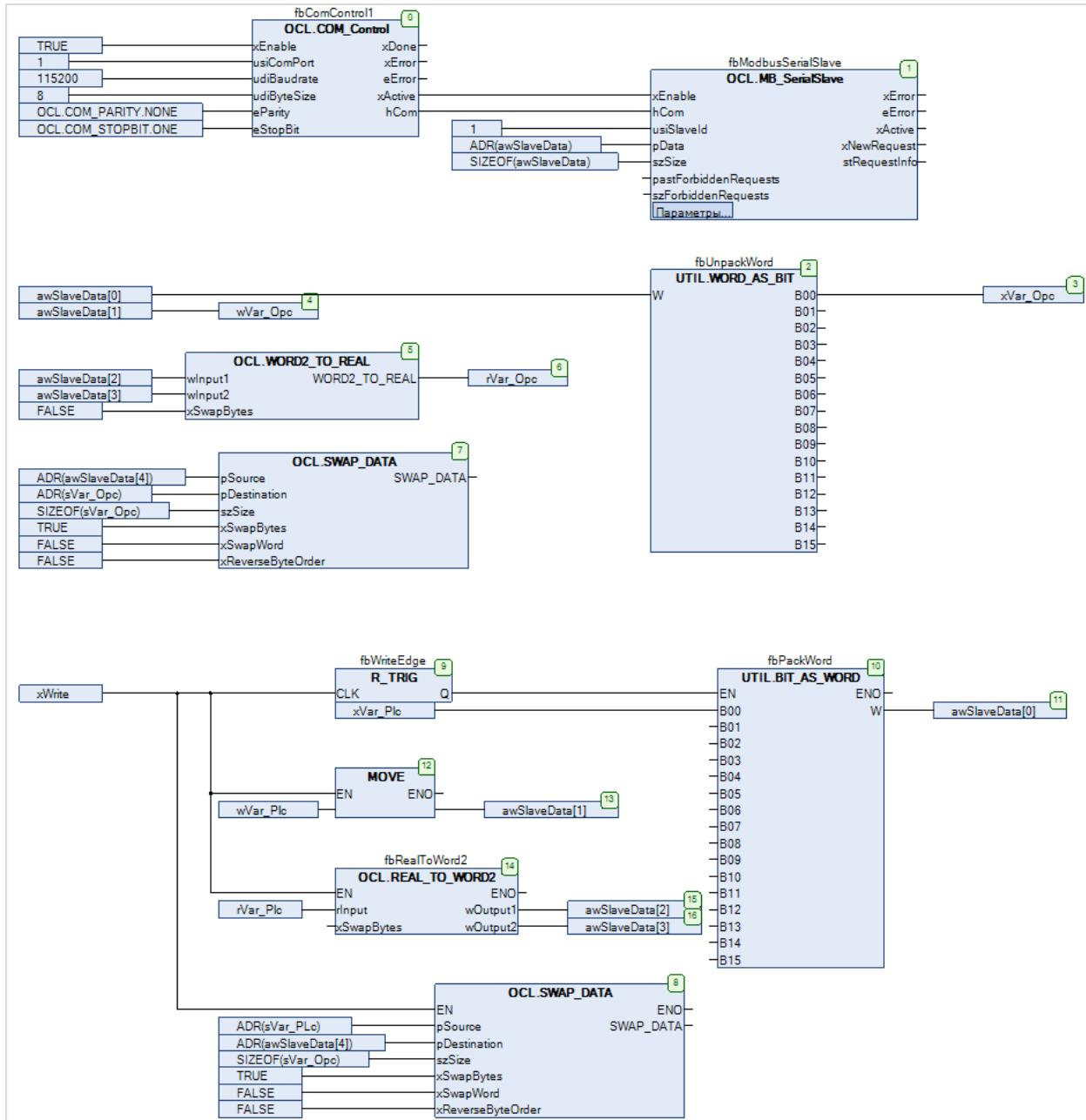
Рисунок 5.9.14 – Код программы на языке CFC
