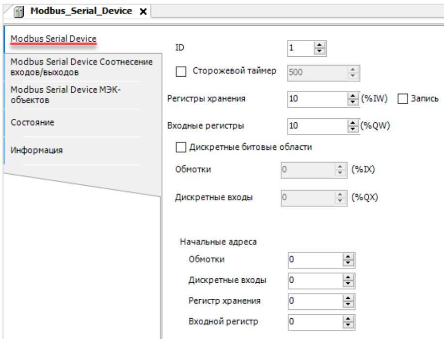
Рисунок 4.3.3 – Настройки компонента Modbus Serial Device
