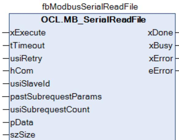
Рисунок 5.6.5 – Внешний вид ФБ MB\_SerialReadFile на языке CFC
