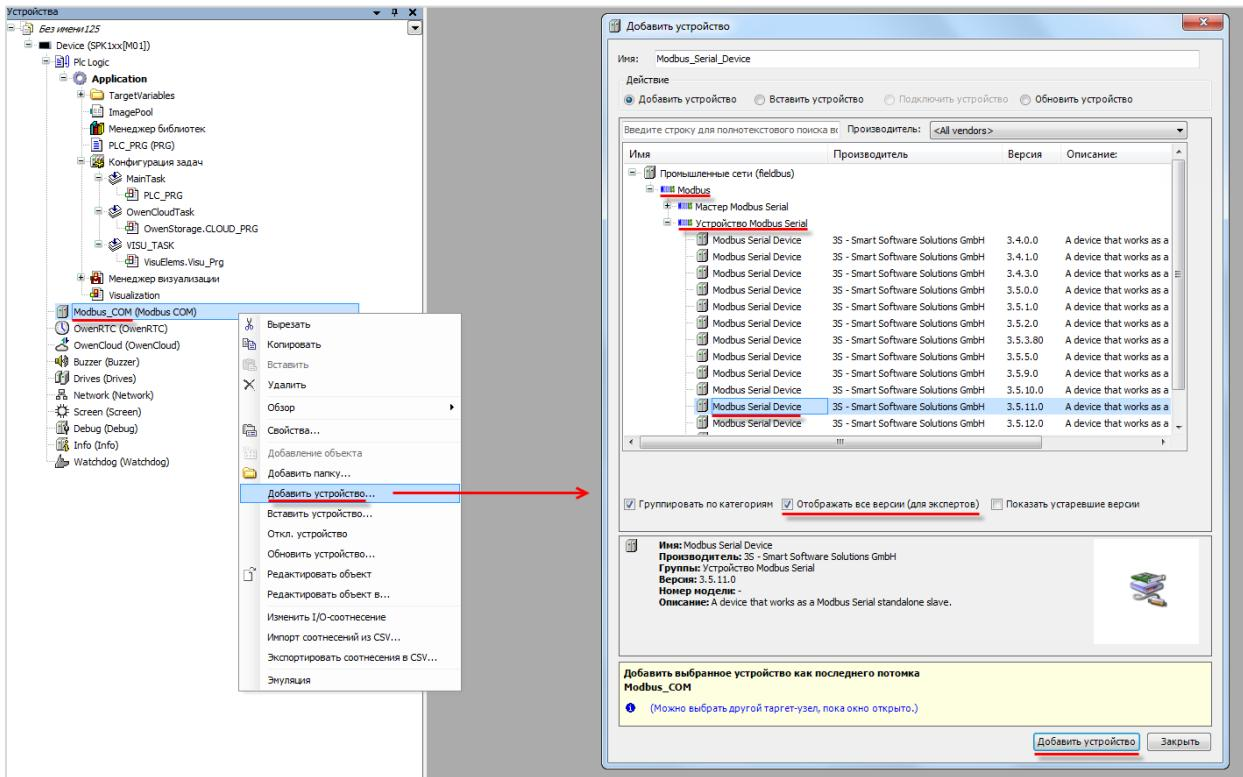
Рисунок 4.3.2 – Добавление компонента Modbus Serial Device
