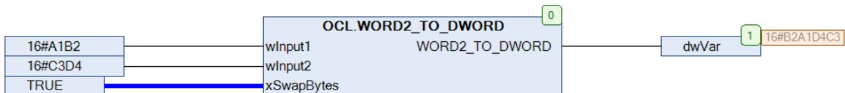
Рисунок 5.8.6 – Пример использования функции WORD2\_TO\_DWORD на языке CFC
