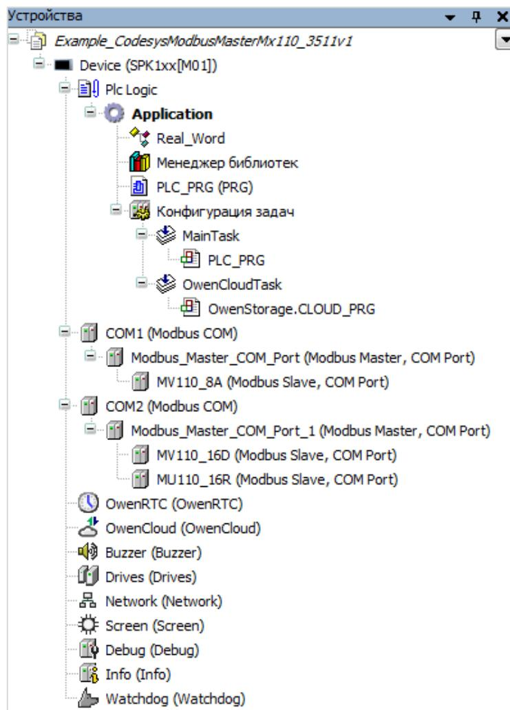
Рисунок 4.9.13 – Внешний вид дерева проекта после добавления slave-устройств
