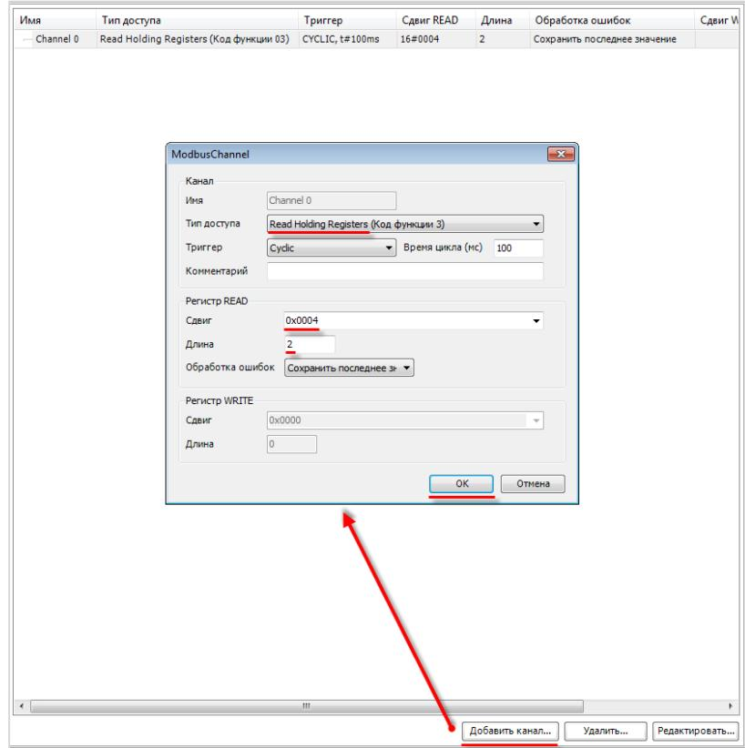
**Рисунок 4.9.15 – Добавление канала в конфигурацию slave-устройства MV110\_8A**
