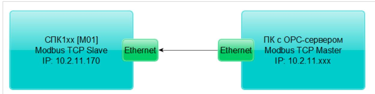
**Рисунок 5.9.33 – Структурная схема примера**
