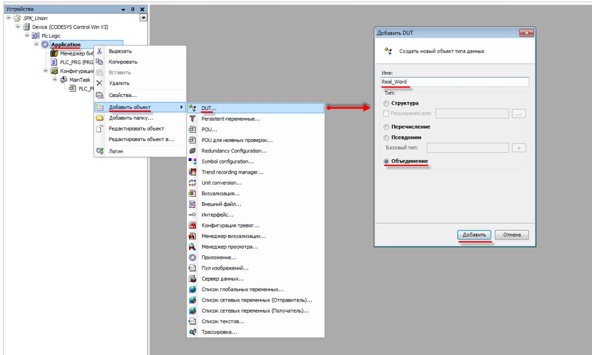
Рисунок 4.8.1 – Добавление объединения в проект CODESYS
