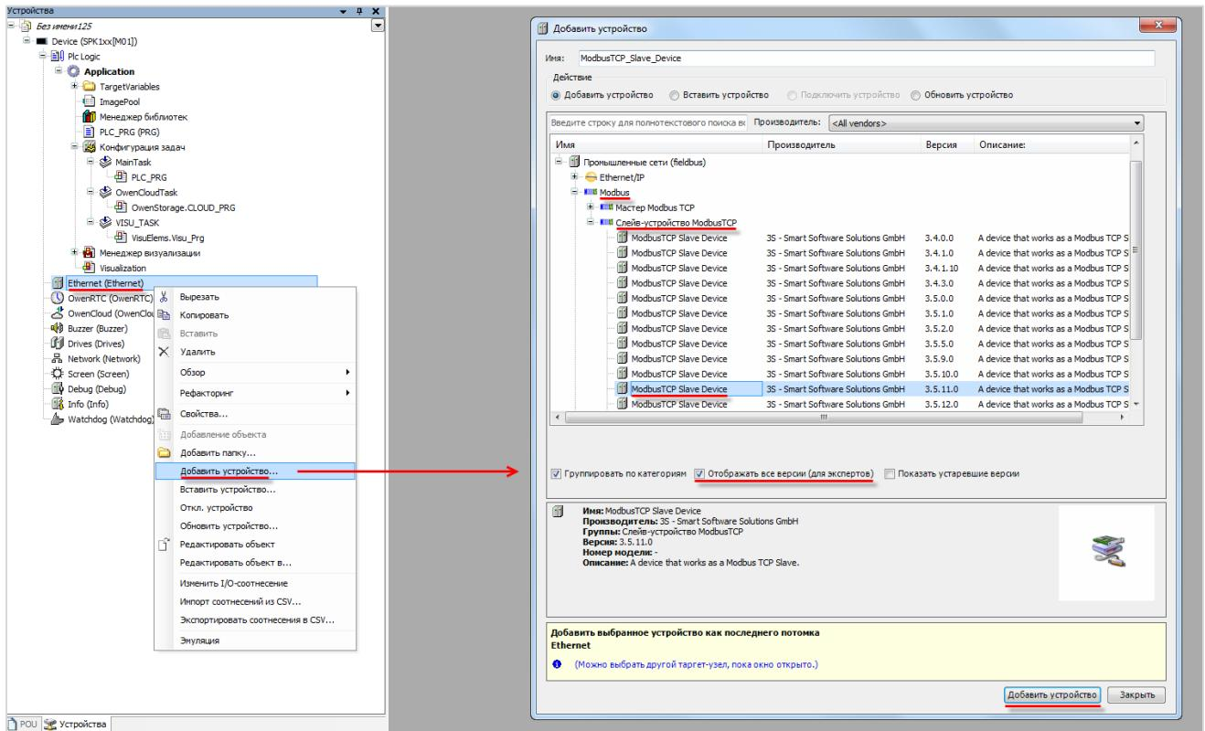
**Рисунок 4.5.2 – Добавление компонента Modbus TCP Slave Device**
