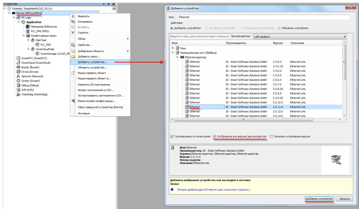
Рисунок 4.11.7 – Добавление компонента Ethernet
