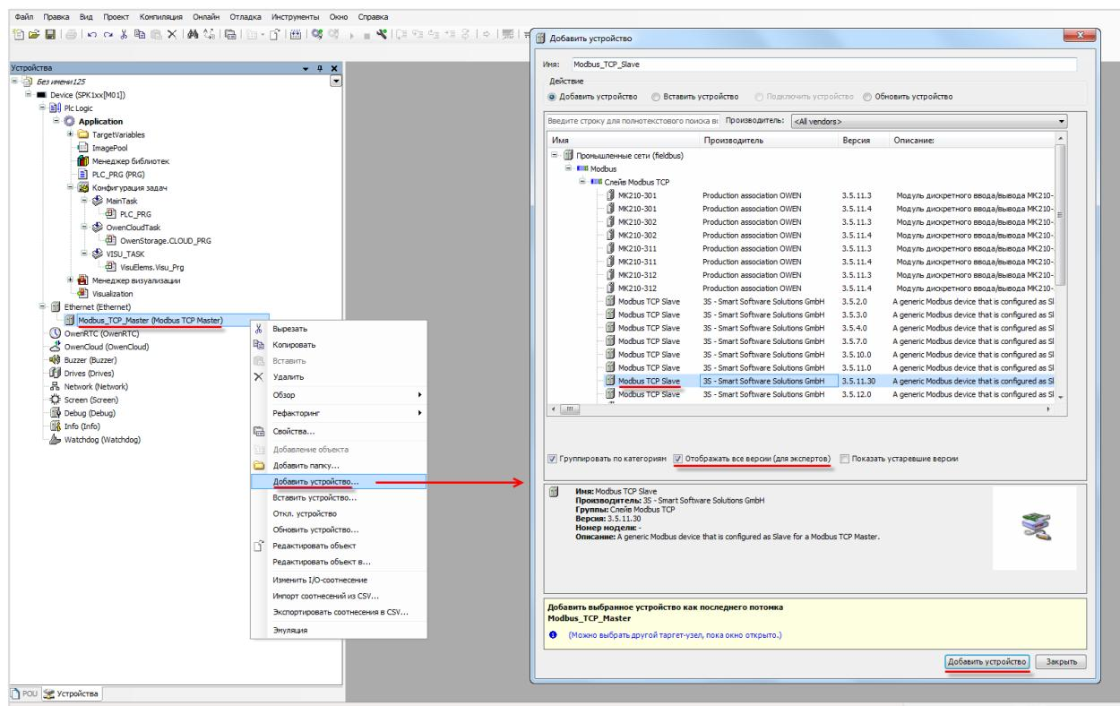
Рисунок 4.4.6 – Добавление компонента Modbus TCP Slave
