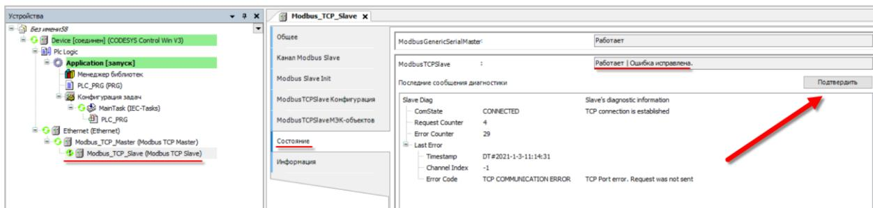
Рисунок 4.6.11 – Вкладка Состояние в компоненте Modbus TCP Slave
