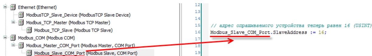
Рисунок 4.6.5 – Изменение заданного адреса опрашиваемого slave-устройства
