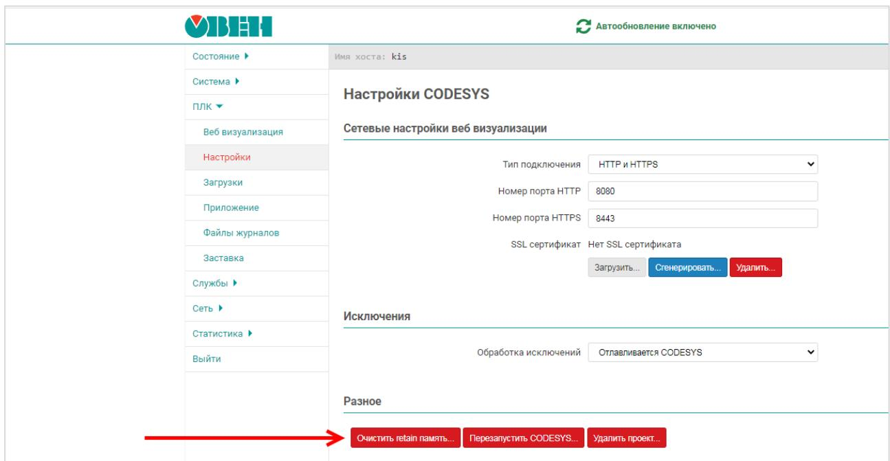
**Рисунок 8.32 – Очистка retain-памяти в web-конфигураторе**
