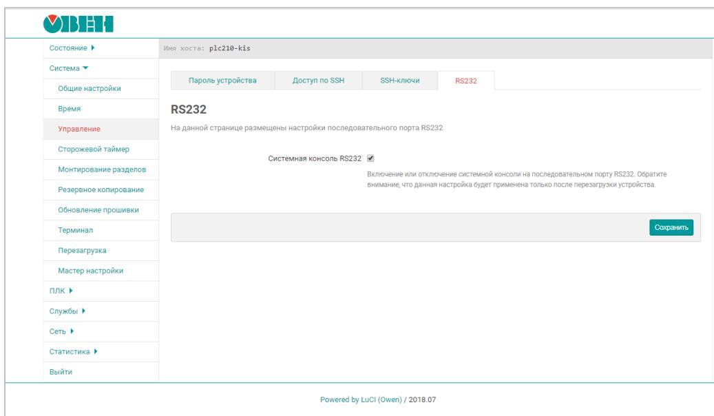
Рисунок 13.5 – Переключение интерфейса RS-232 в режим Debug
