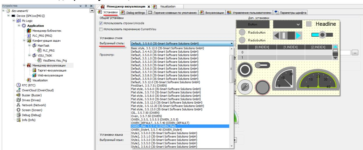
Рисунок 7.19 – Выбор стиля визуализации в проекте CODESYS
