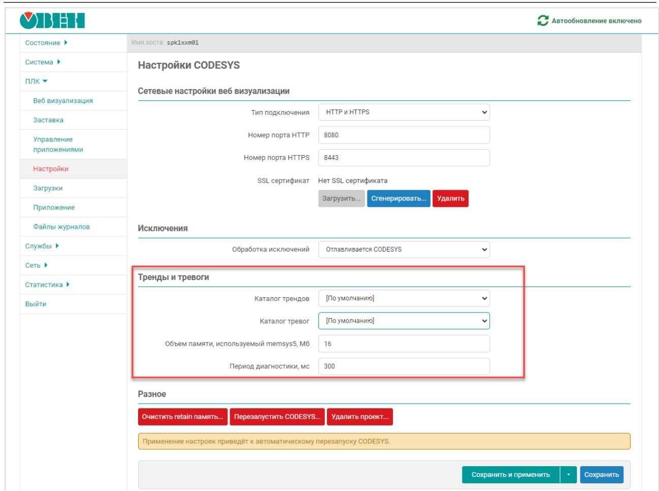
Рисунок 7.29 – Настройки трендов и тревог в web-конфигураторе
