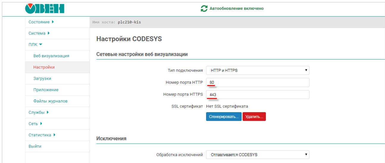
**Рисунок 11.3 – Изменения номеров портов web-визуализации**
