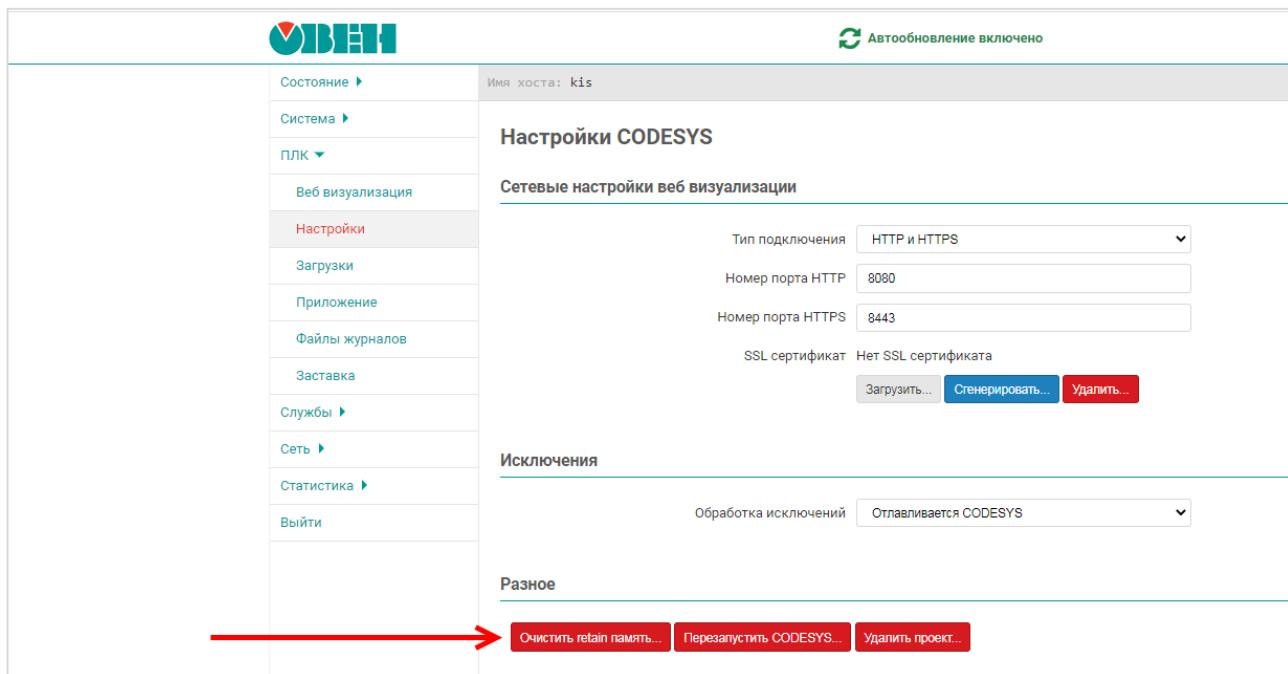
Рисунок 8.32 – Очистка retain-памяти в web-конфигураторе
