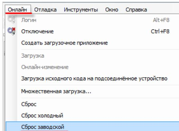
Рисунок 8.2 – Удаление проекта из контроллера
