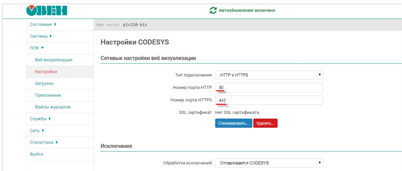
**Рисунок 11.3 – Изменения номеров портов web-визуализации**
