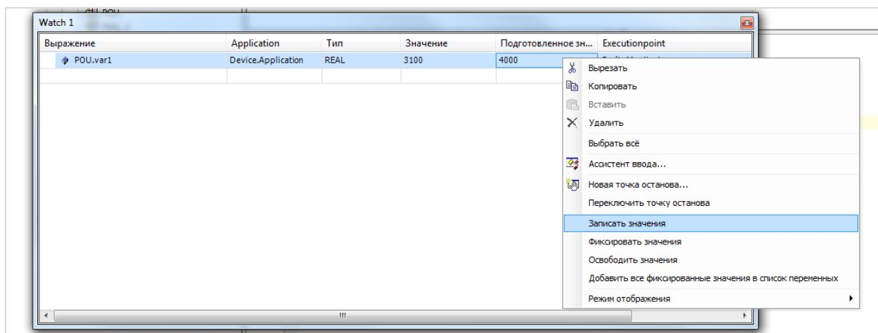
Рисунок 8.15 – Изменения значения переменной в процессе отладки
