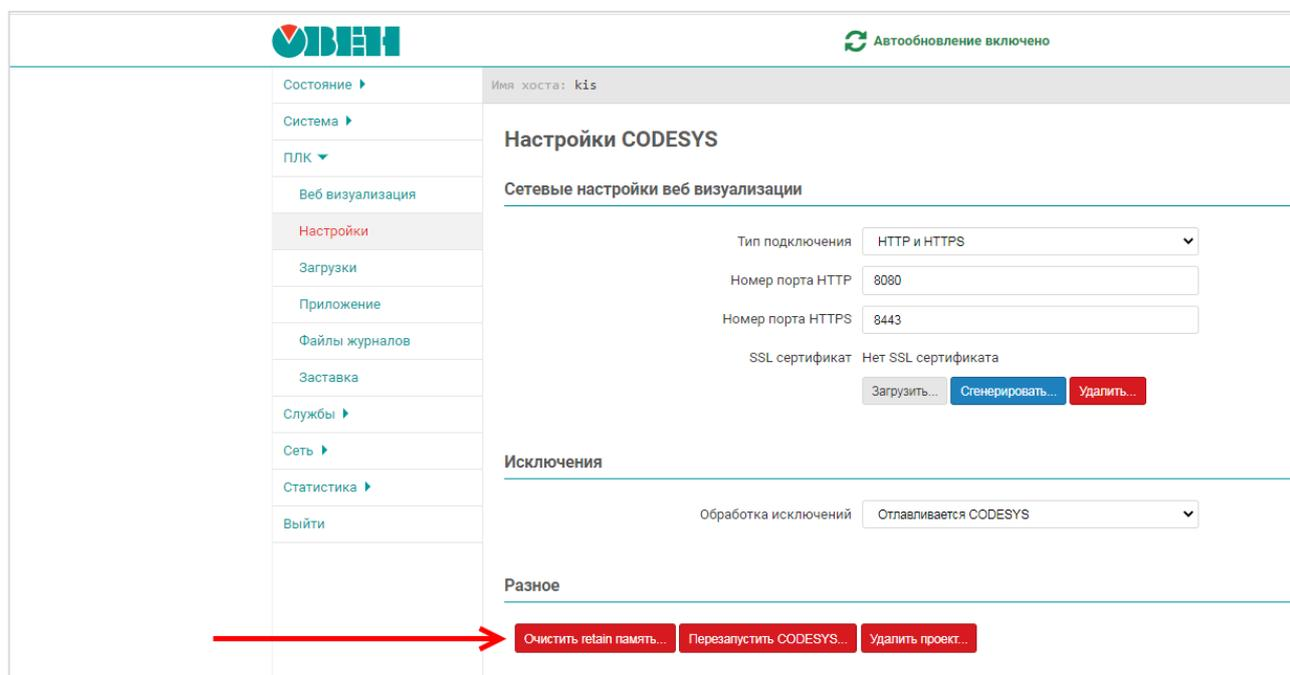
Рисунок 8.32 – Очистка retain-памяти в web-конфигураторе
