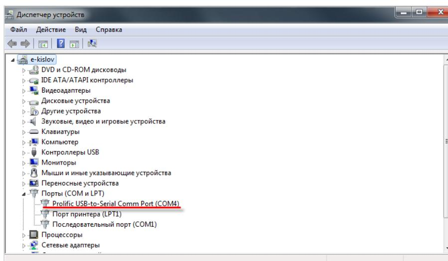
Рисунок 13.6 – Номер COM-порта ПК в Диспетчере устройств
