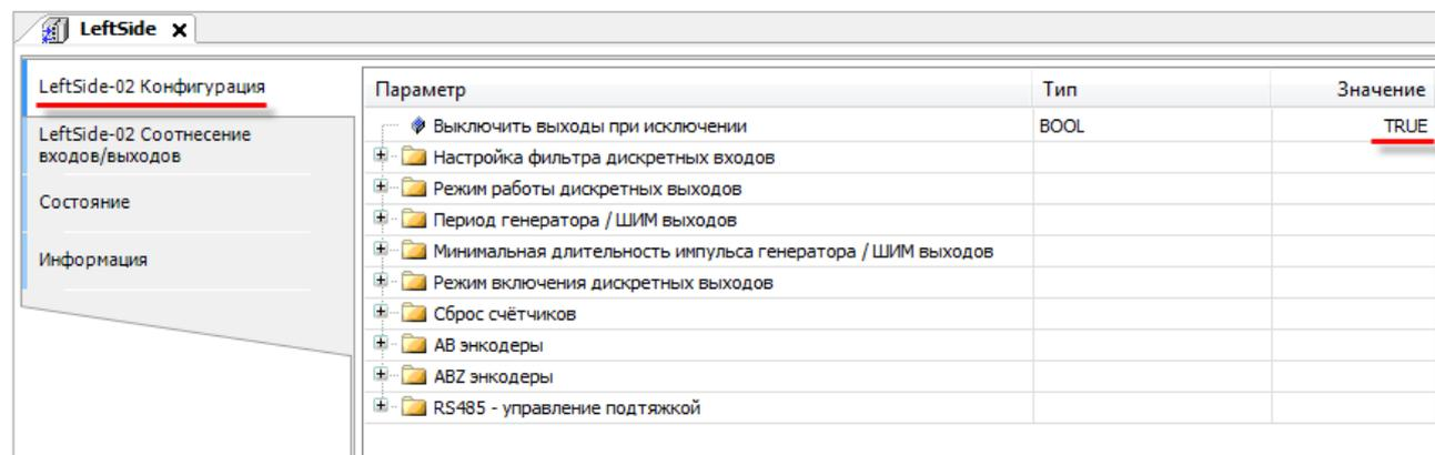
Рисунок 7.33 – Режим обработки выходов при остановке приложения
