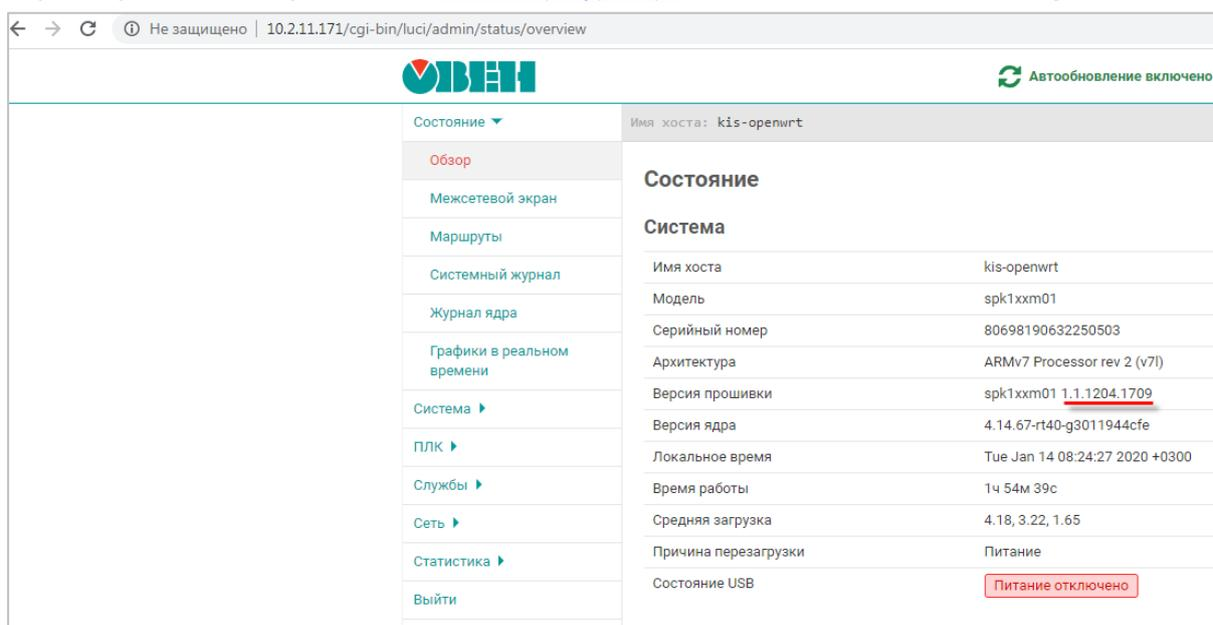
Рисунок 3.1 – Отображение версии прошивки контроллера в web-конфигураторе
