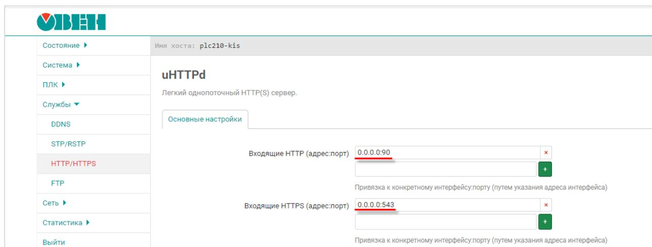
Рисунок 11.2 – Изменения номеров портов web-сервера конфигулятора
