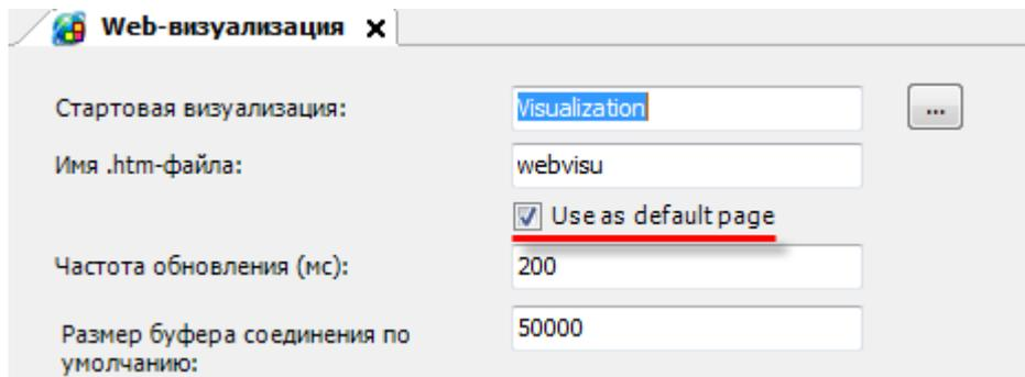
Рисунок 11.1 – Настройка web-визуализации
