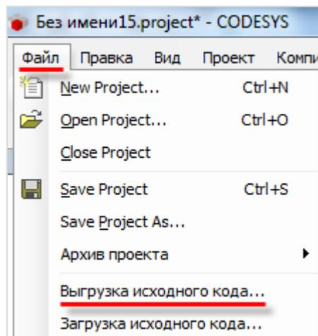
Рисунок 8.4 – Команда выгрузки проекта из контроллера
