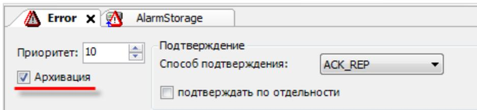
Рисунок 7.27 – Настройка архивации для класса тревог
