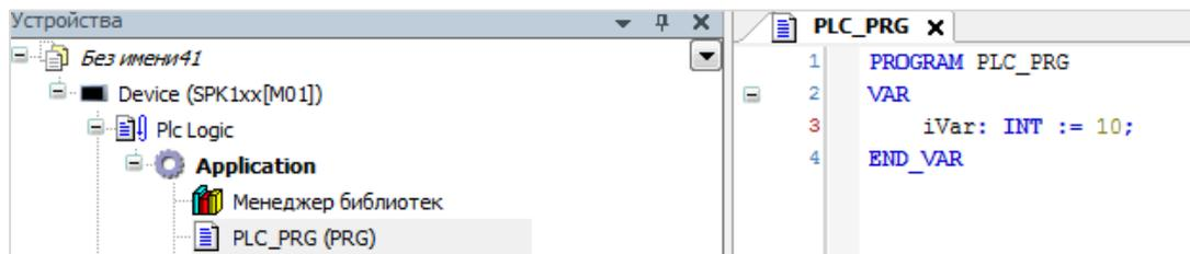
Рисунок 7.7 – Объявление переменной в программе PLC\_PRG
