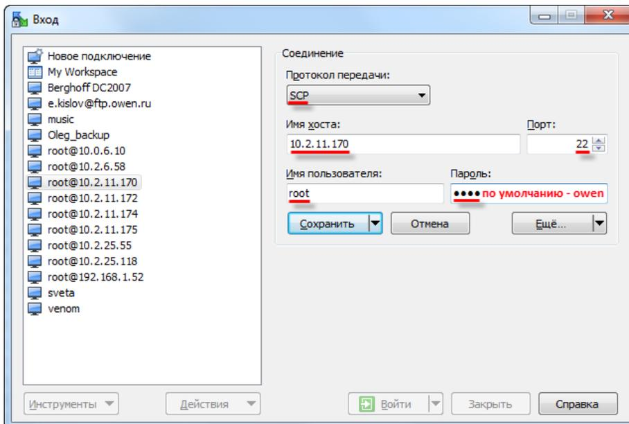
Рисунок 13.8 – Настройки подключения в программе WinSCP
