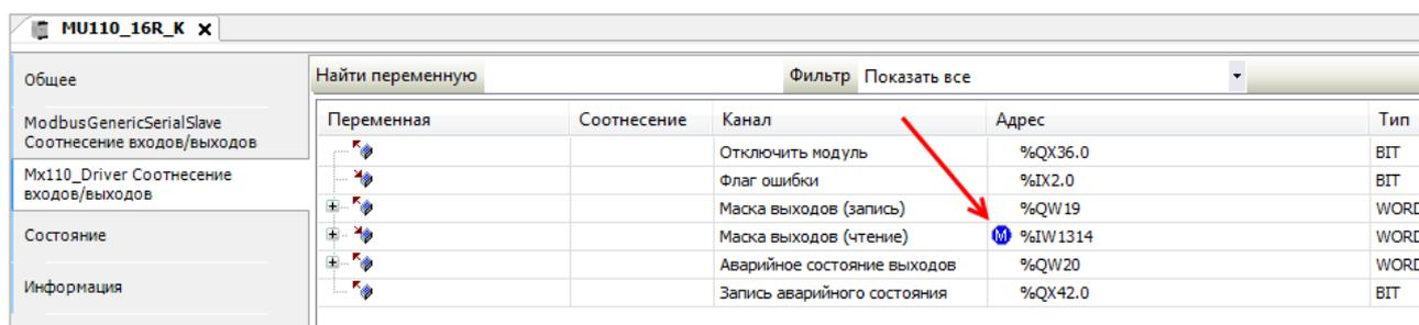
Рисунок 8.29 – Признак ручного распределения адресов каналов
