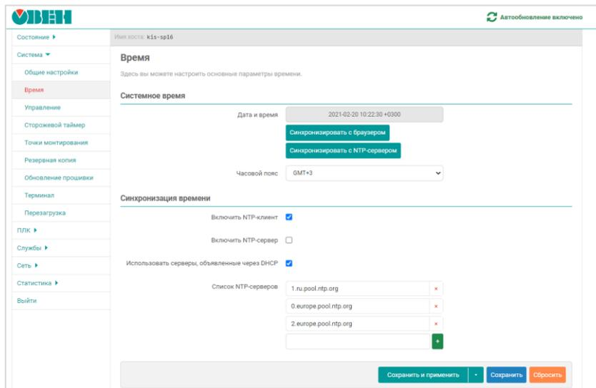
Рисунок 12.2 – Настройки синхронизации времени по NTP
