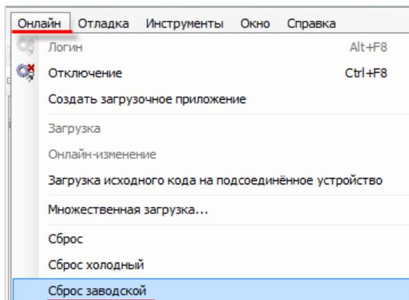
Рисунок 8.2 – Удаление проекта из контроллера
