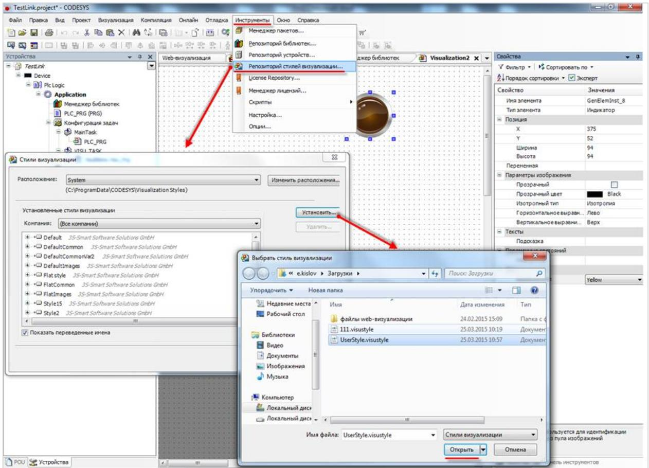
Рисунок 7.18 – Установка стиля визуализации в CODESYS
