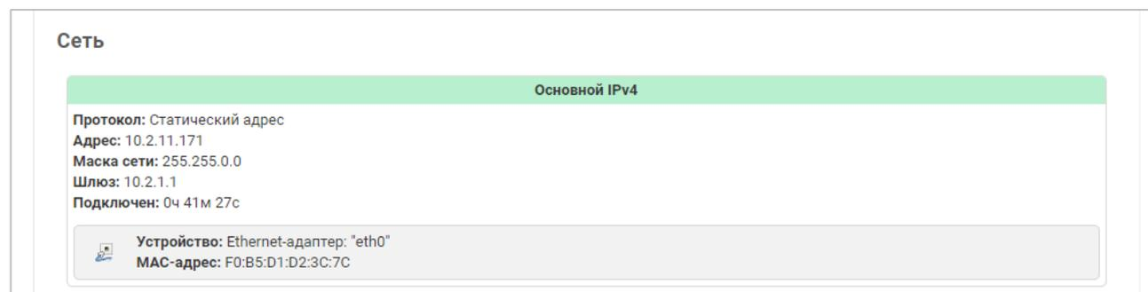
Рисунок 6.6 – Отображение сетевых настроек в web-конфигураторе
