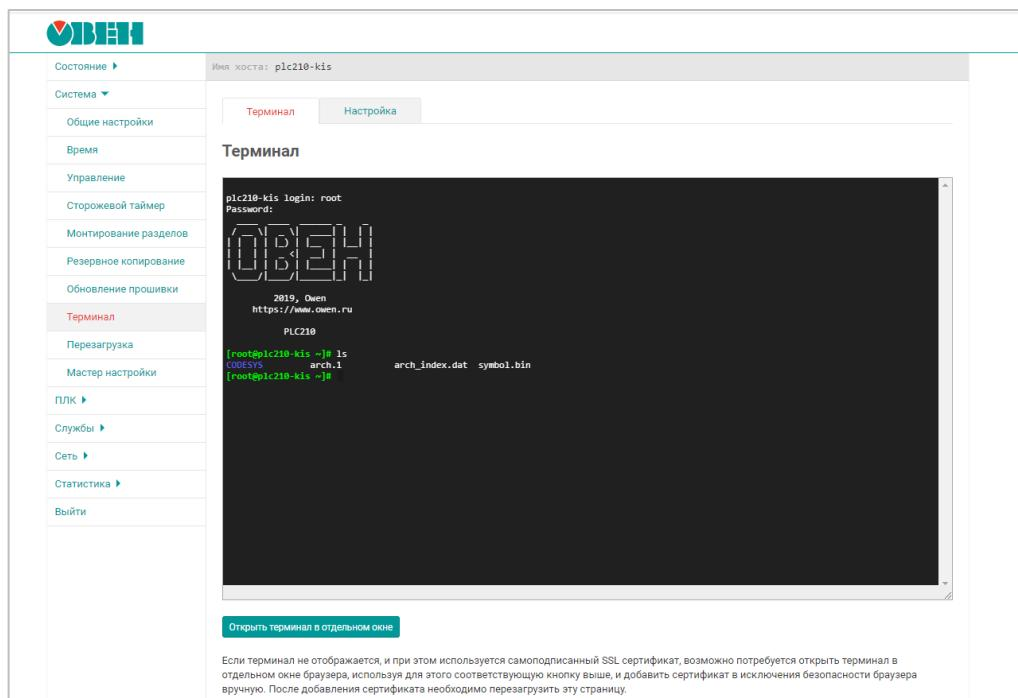
**Рисунок 13.3 – Работа с терминалом на вкладке Сеть/Терминал**
