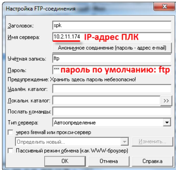
Рисунок 9.1 – Настройки FTP-соединения в файловом менеджере Total Commander
