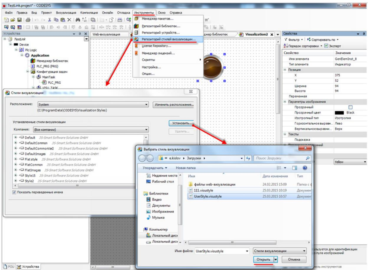
Рисунок 7.18 – Установка стиля визуализации в CODESYS
