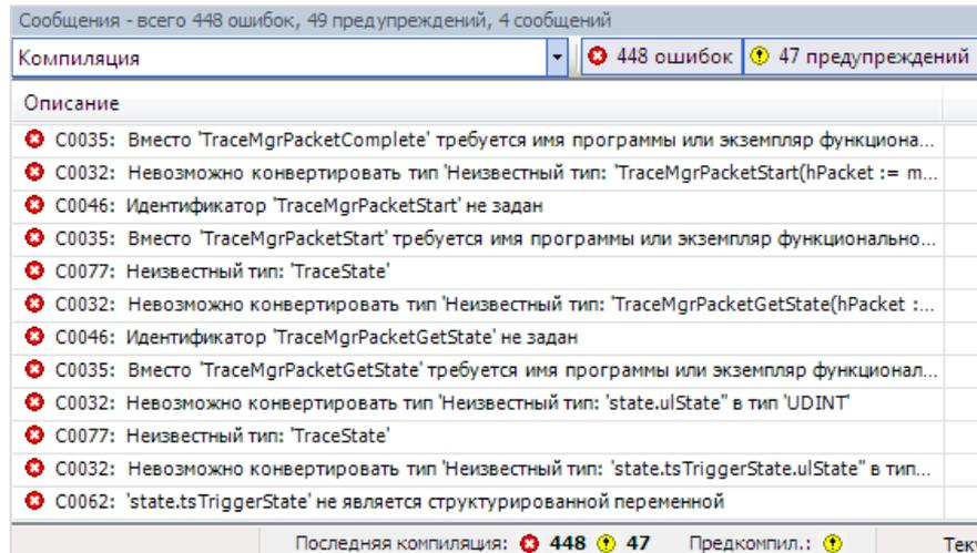
Рисунок 8.20 – Ошибки, вызванные отсутствием компонентов CODESYS
