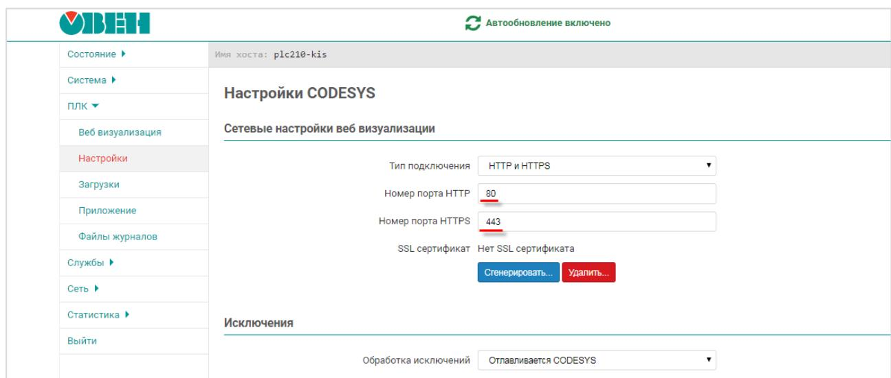
Рисунок 11.3 – Изменения номеров портов web-визуализации
