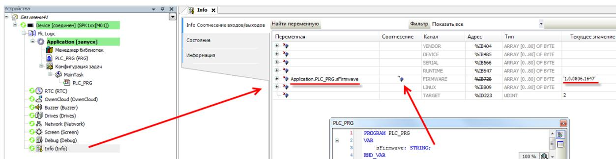
Рисунок 3.2 – Отображение версии прошивки контроллера в CODESYS
