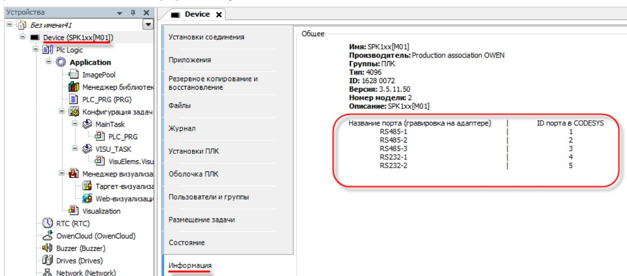
Рисунок 10.1 – Таблица номеров COM-портов в среде CODESYS
