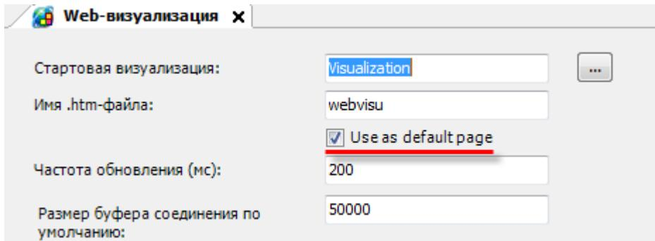
Рисунок 11.1 – Настройка web-визуализации
