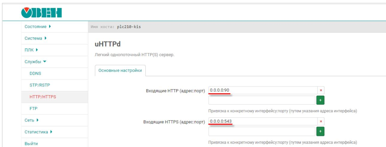
Рисунок 11.2 – Изменения номеров портов web-сервера конфигуратора
