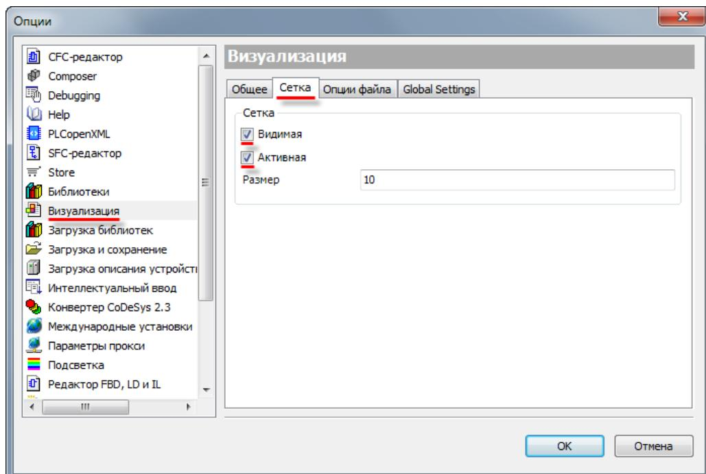
Рисунок 7.4 – Включение сетки в Редакторе визуализации
