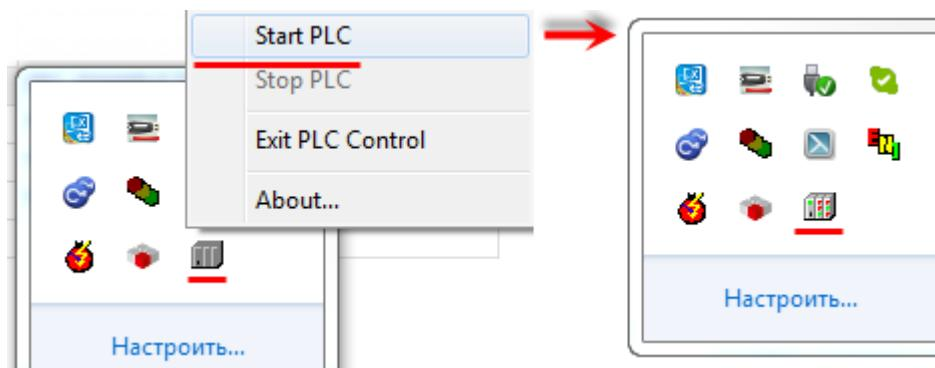
Рисунок 8.9 – Запуск виртуального контроллера
