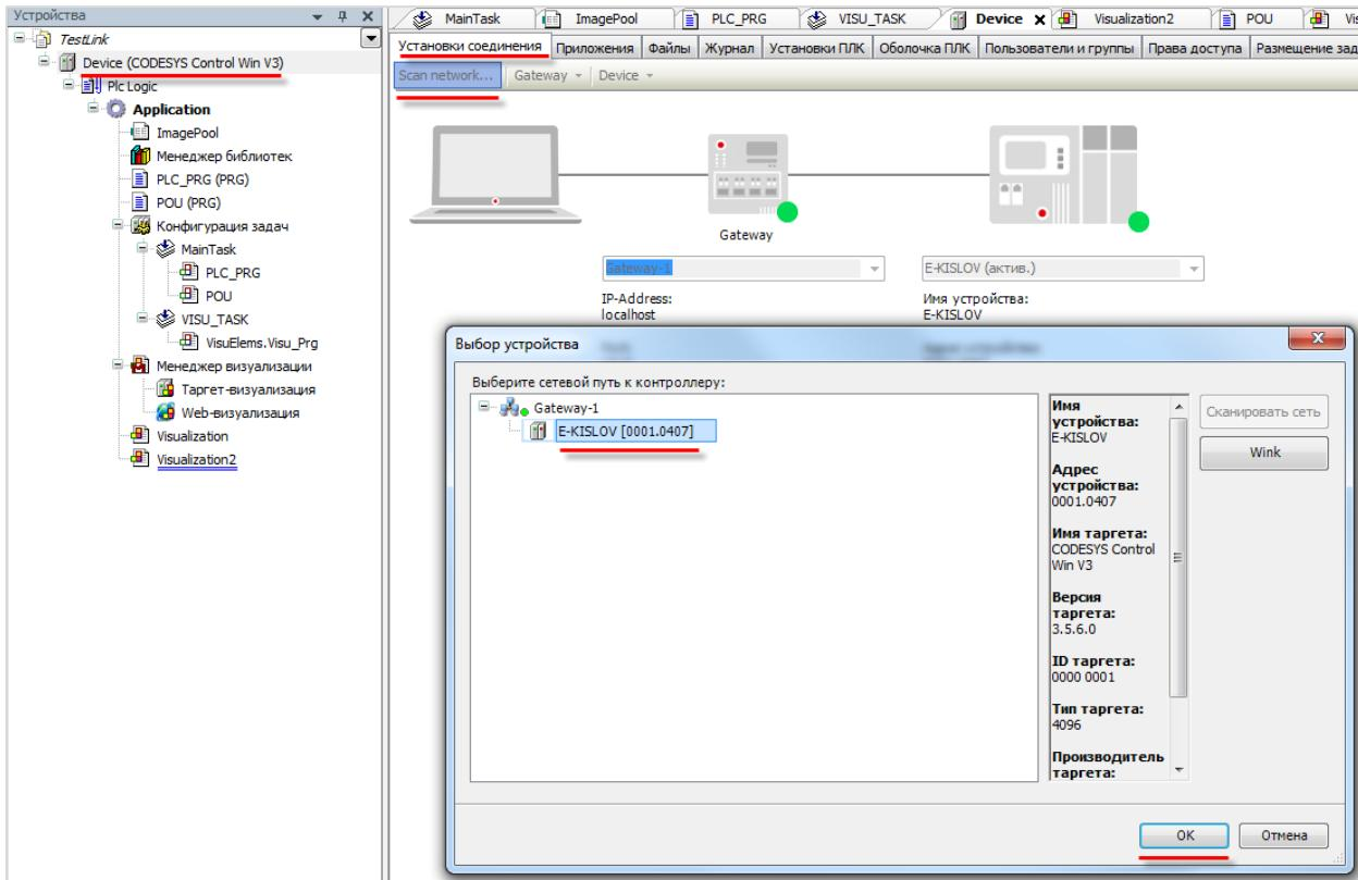
Рисунок 8.11 – Окно сканирования сети. Подключение к виртуальному контроллеру
