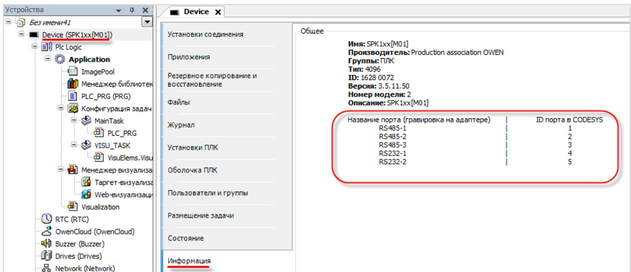
Рисунок 10.1 – Таблица номеров COM-портов в среде CODESYS
