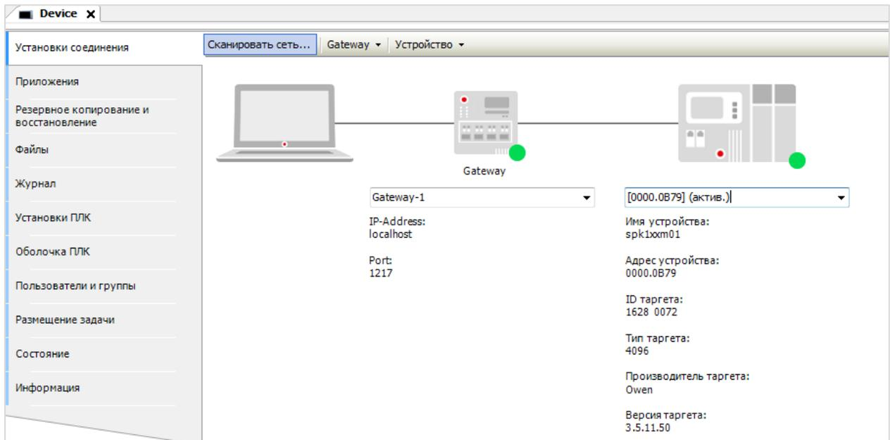
Рисунок 6.4 – Результат успешной установки связи
