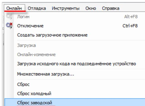
Рисунок 8.2 – Удаление проекта из контроллера
