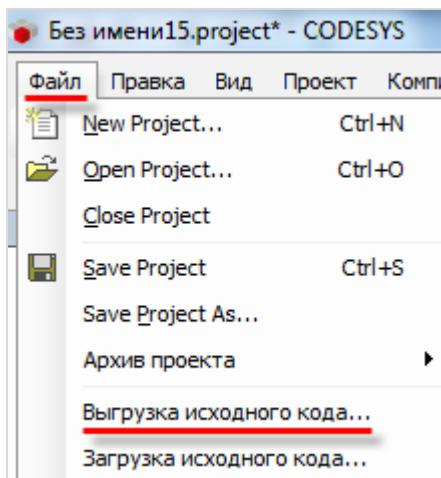
Рисунок 8.4 – Команда выгрузки проекта из контроллера
