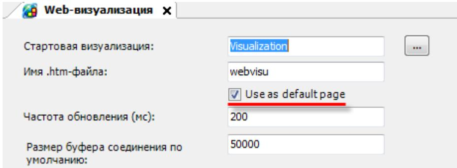
Рисунок 11.1 – Настройка web-визуализации
