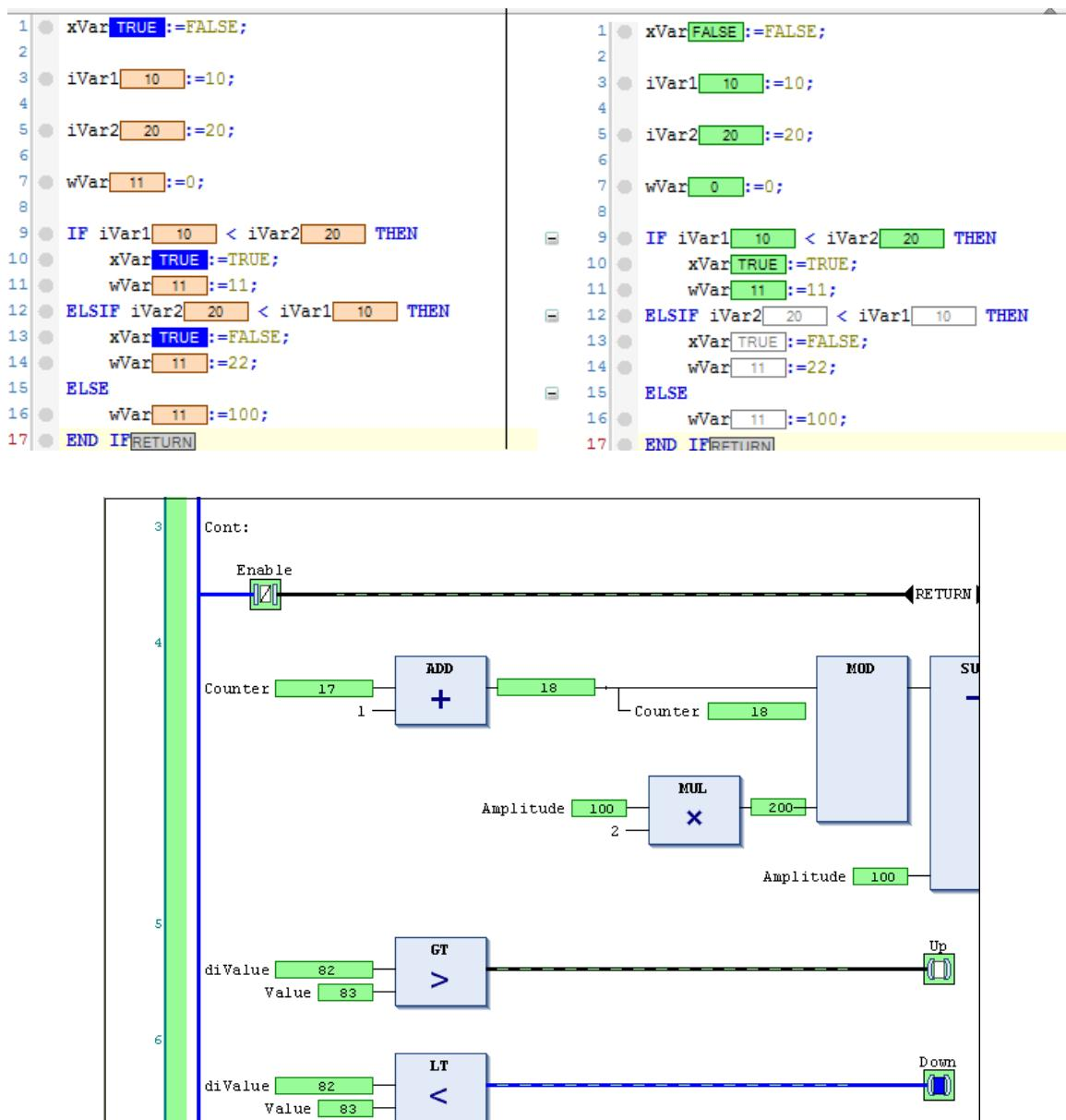
Рисунок 8.25 – Отображение промежуточных значений переменных
