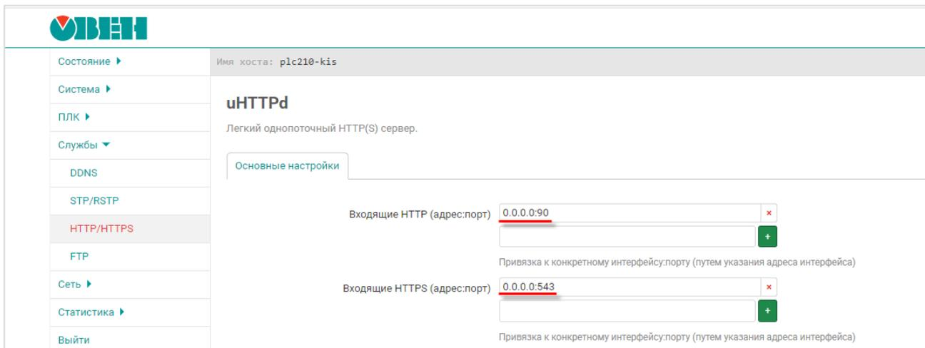
Рисунок 11.2 – Изменения номеров портов web-сервера конфигуратора
