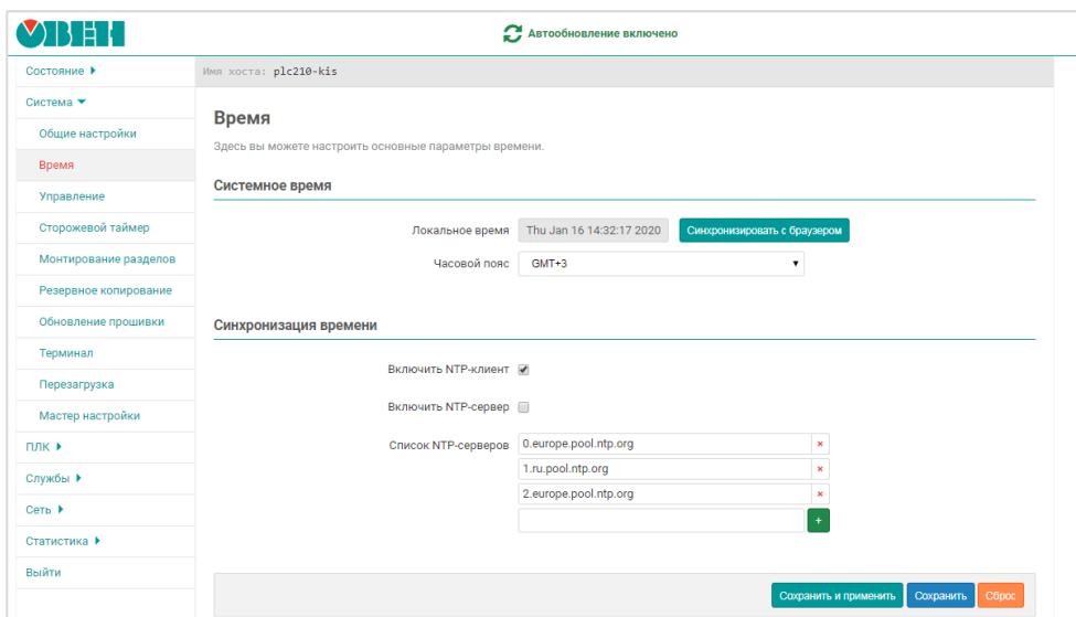
Рисунок 12.2 – Настройки синхронизации времени по NTP
