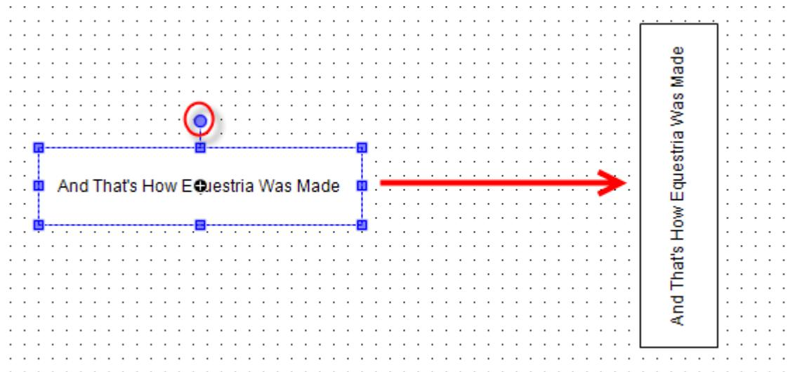
**Рисунок 7.26 – Вертикальный текст в визуализации CODESYS**
