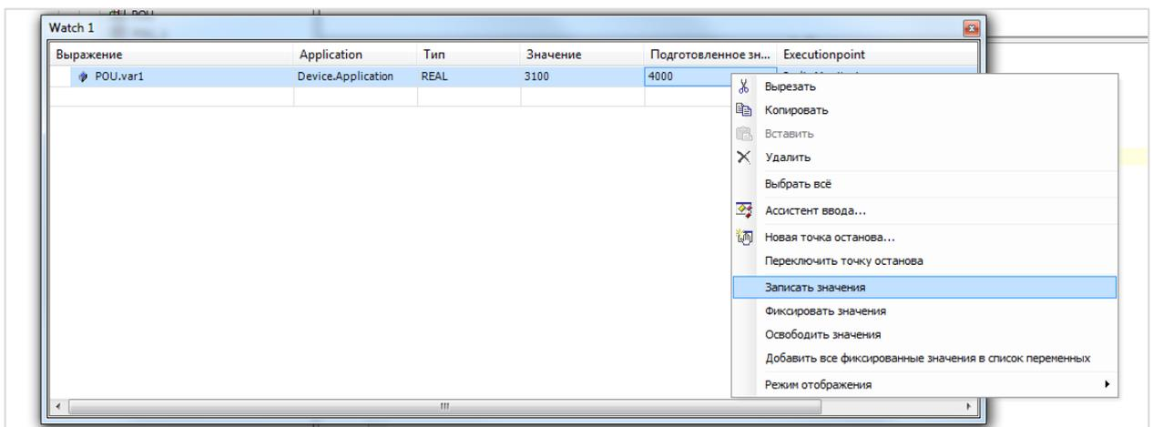
Рисунок 8.15 – Изменения значения переменной в процессе отладки
