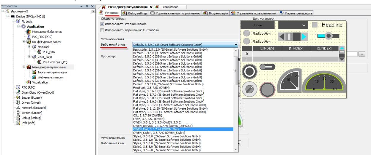
Рисунок 7.19 – Выбор стиля визуализации в проекте CODESYS
