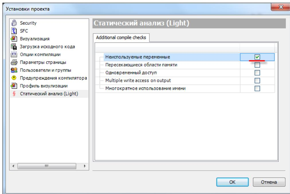
Рисунок 8.27 – Внешний вид вкладки Статический анализ
