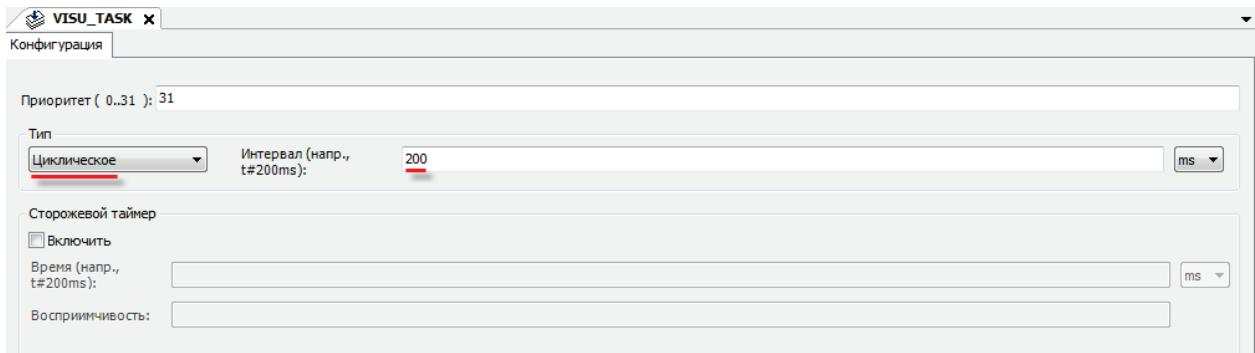
Рис. 12.7. Настройки времени цикла задачи визуализации
