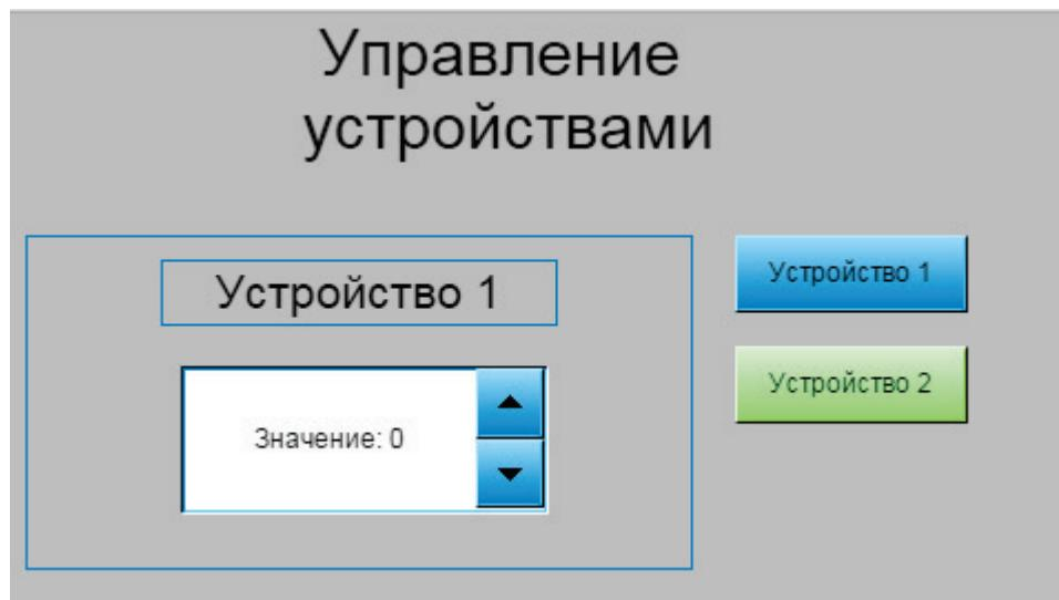
Рис. 11.4.4.2. Выделенная кнопка не соответствует отображаемому устройству
