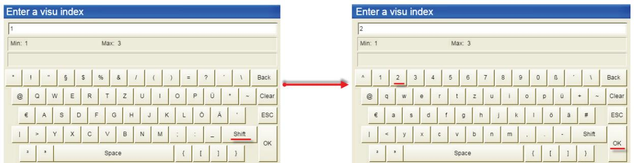
Рис. 11.3.1.17. Переключение раскладки экранной клавиатуры
