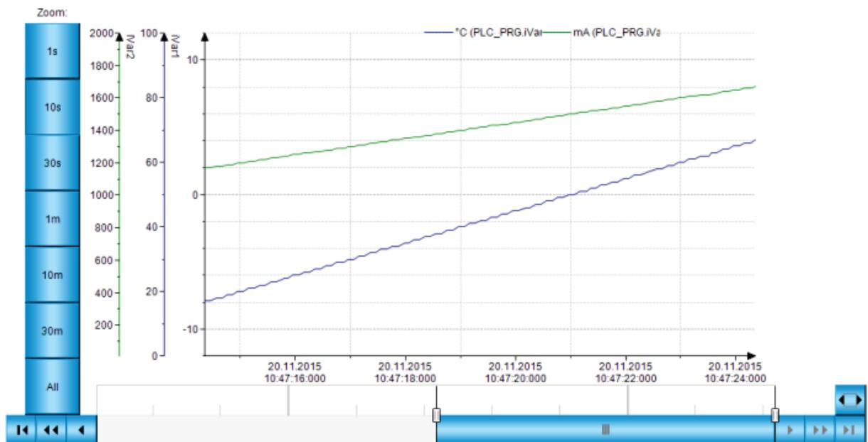
Рис. 13.5. Тренд с двумя осями в визуализации CODESYS
