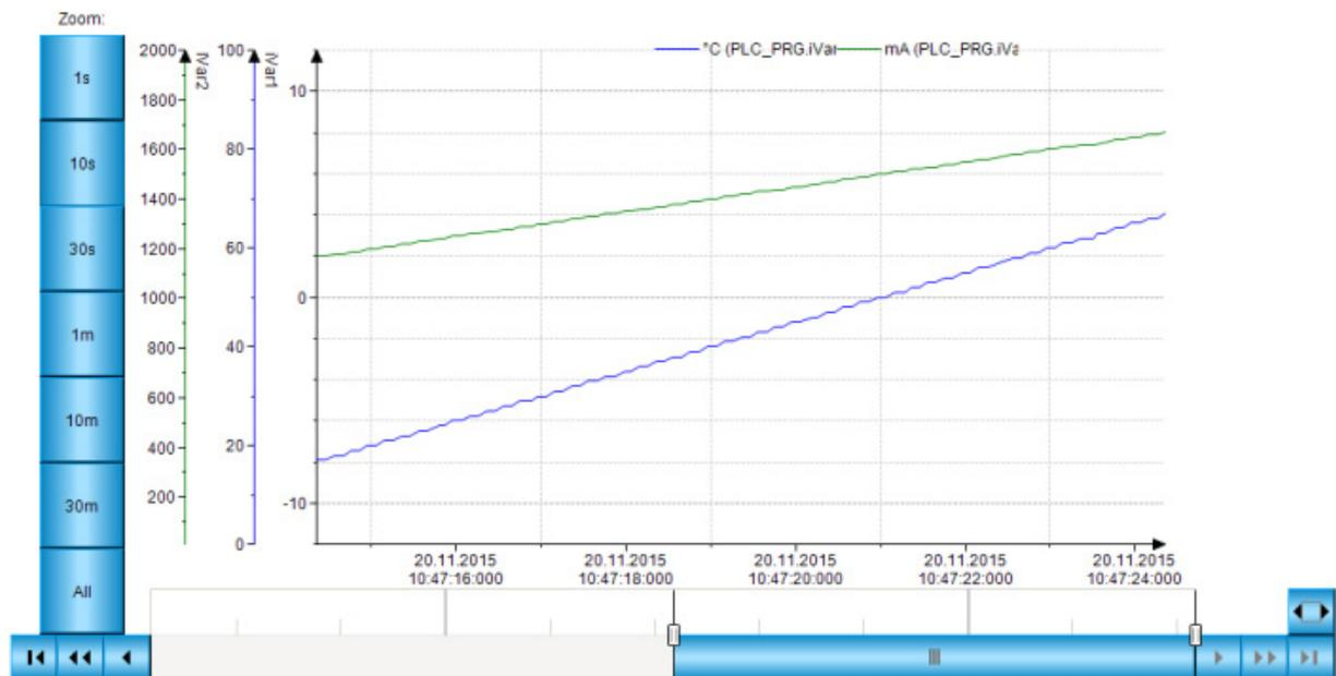
Рис. 13.5. Тренд с двумя осями в визуализации **CODESYS**
