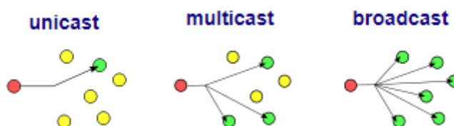
Рис. 2.1. Схемы маршрутизации UDP
