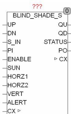
BLIND\_SHADE\_S ist eine wesentlich vereinfachte Funktion von BLIND\_SHADE speziell für die Verwendung mit Rollos. Bei diesen muss kein Lamellenwinkel für die Beschattung berechnet werden, sondern lediglich sichergestellt, dass bei Sonnenschein das Rollo weit genug geschlossen ist.
