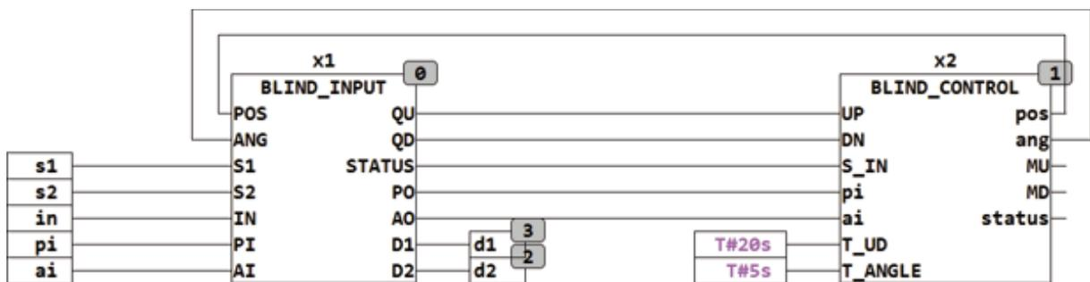
Die Verwendung weiterer BLIND Module ist optional und dient dazu den Funktionsumfang zu erweitern. BLIND\_INPUT und BLIND\_CONTROL ergeben bereits eine vollwertige Jalousiesteuerung.
