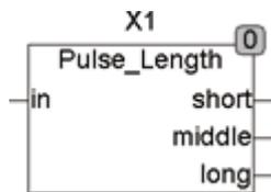
PULSE\_LENGTH setzt bei einem Eingangspuls an IN einen der 3 Ausgänge. Der Ausgang SHORT wird für einen Zyklus TRUE, wenn der Eingangspuls kleiner als T\_SHORT ist. Der Ausgang MIDDLE wird für einen Zyklus TRUE, wenn der Eingangspuls zwischen T\_SHORT und T\_LONG lang ist. Der Ausgang LONG wird gesetzt, sobald der Eingangsimpuls T\_LONG überschritten hat und bleibt solange auf TRUE, wie der Eingangsimpuls auf TRUE bleibt.
