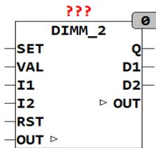
DIMM\_2 ist ein intelligenter Dimmer für 2-Taster Bedienung. Der Dimmer kann über Setup-Variablen eingestellt werden. Die Zeit  $T_{\text{DEBOUNCE}}$  dient zur Entprellung des Tasters und ist standardmäßig auf 10ms eingestellt. Eine Einschaltbegrenzung  $T_{\text{ON\_MAX}}$  schaltet den Ausgang automatisch ab, wenn sie überschritten wird. Die Zeiten  $T_{\text{DIMM\_Start}}$  und  $T_{\text{DIMM}}$  legen das Zeitverhalten des Dimmers fest.
