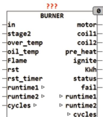
BURNER ist ein Steuerinterface für Öl- oder Gasbrenner mit Betriebszähler und Kilowattstundenzähler. Der Baustein steuert einen zweistufigen Bren-
