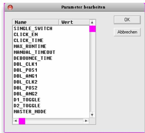
auch die Setup-Parameter, im Aufruf übergeben werden. Die Setup-Parameter werden einfach nach den normalen Eingängen angefügt. Die Parameter werden in der grafischen Oberfläche durch Doppelklick bearbeitet und dann wie Konstanten unter IEC61131 eingegeben. Es ist Dabei zu beachten dass Zeiten mit T#200ms und TRUE und FALSE in Großbuchstaben geschrieben sein müssen.
