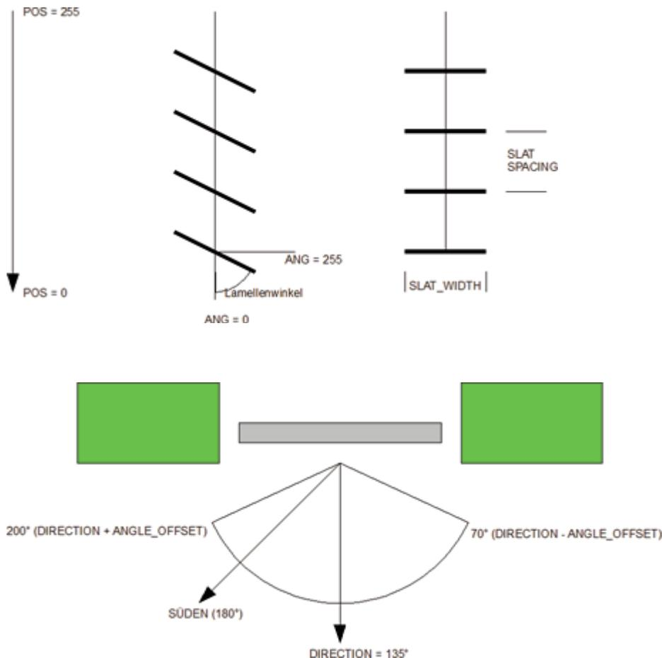
Die folgende Grafik zeigt eine nach Süd-Ost gerichtete Fassade mit  $DIRECTION = 135^\circ$  und  $ANGLE\_OFFSET = 65^\circ$ :
