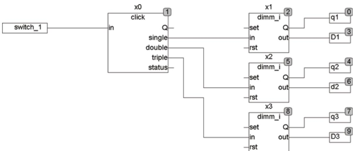
Beispiel 2 zeigt CLICK mit einem Dimmer, wobei sich der Dimmer wie ein Dimmer ohne CLICK verhält, jedoch ein kurzer Doppelklick den Ausgang des Dimmers sofort auf 100% setzt und ein Dreifachklick als weiterer Schaltausgang zur Verfügung steht.
