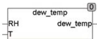
Der Baustein DEW\_TEMP berechnet aus der Relativen Feuchte (RH) und der Temperatur (T in °C) die Taupunkttemperatur. Die Relative Feuchte wird in % angegeben (50 = 50%).
