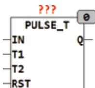
PULSE\_T erzeugt einen Ausgangsimpuls der Länge T2 wenn der Eingang IN kürzer als T1 auf TRUE geht. Bleibt der Eingang IN länger als T1 auf TRUE so folgt der Ausgang Q dem Eingang IN und geht zeitgleich mit IN wieder auf FALSE. Bleibt IN länger als die Zeit T2 auf TRUE wird der Aus-
