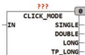
CLICK\_MODE ist ein Taster Interface das sowohl einfachen Klick, Doppelklick oder Lange Tastendrucke dekodiert. Mit kurzen Impulsen wird ein einfacher oder Doppelklick dekodiert und schaltet entsprechend die Ausgänge SINGLE oder DOUBLE für jeweils einen Zyklus ein. Ist der Puls länger als die T\_LONG, so wird der Ausgang TP\_LONG für einen Zyklus auf TRUE gesetzt und der Ausgang LONG bleibt solange TRUE bis der Eingang IN wieder auf FALSE geht.
