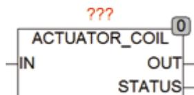
ACTUATOR\_COIL dient zur Ansteuerung von einfachen Ventilen. Der Ausgang OUT folgt dabei dem Eingangssignal IN. Wird die Setup Variable
