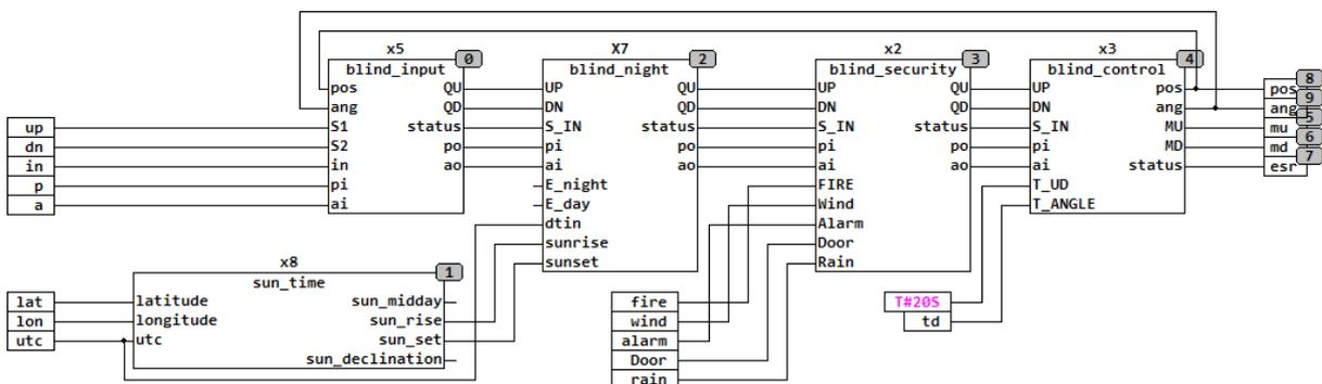
BLIND\_SECURITY muss unbedingt direkt vor BLIND\_CONTROL eingesetzt werden. Sollten andere Module zwischen BLIND\_SECURITY und BLIND\_CONTROL eingebaut werden so sind die Sicherheitsfunktionen nicht mehr gewährleistet.
