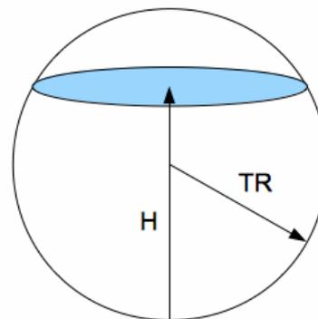
TANK\_VOL2 berechnet den Inhalt eines Kugelförmigen Tanks der bis zur Höhe H gefüllt ist.
