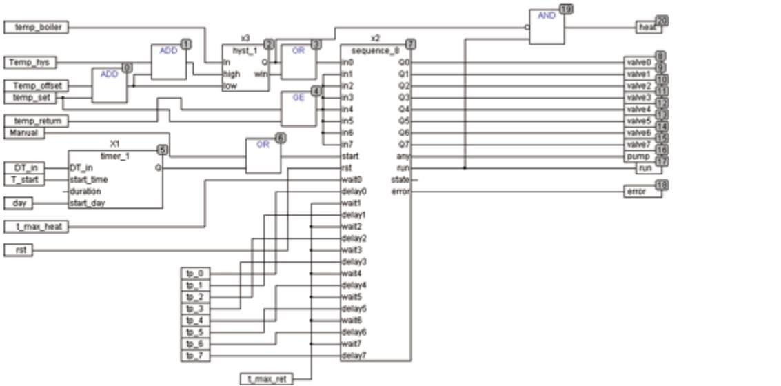
Das Folgende Beispiel zeigt eine Simulation für 2 Desinfektionskreise mit Traceaufzeichnung. In diesem Aufbau ist VALVE2 auf den Eingang RST geschaltet und unterbricht damit die Sequenz nach 2 Kreisen:
