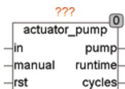
ACTUATOR\_PUMP ist ein Pumpeninterface mit Betriebsstundenzähler. Die Pumpe kann sowohl mit IN oder Manual eingeschaltet werden. Die Setup-Variablen MIN\_ONTIME und MIN\_OFFTIME legen eine minimale Einschaltdauer und eine minimale Laufzeit fest. Wird der Eingang IN kürzer als MIN\_ONTIME auf TRUE gesetzt, so läuft die Pumpe weiter bis die minimale Laufzeit erreicht ist. Wird der Eingang IN länger als MIN\_ONTIME auf TRUE gesetzt, läuft die Pumpe bis IN wieder FALSE ist.
