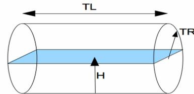
TANK\_VOL1 berechnet den Inhalt eines Rohrförmigen Tanks der bis zur Höhe H gefüllt ist.
