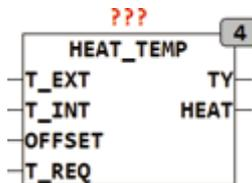
HEAT\_TEMP berechnet die Vorlauftemperatur aus der Außentemperatur nach folgender Formel:
