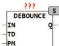
DEBOUNCE kann das Signal von einem Schalter oder Taster entprellen und am Ausgang Q entprellt bereitstellen. Wenn PM = FALSE folgt der Ausgang
