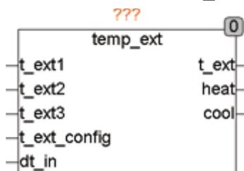
TEMP\_EXT verarbeitet bis zu 3 Außentemperaturfühler und stellt eine durch Mode selektierte Außentemperatur der Heizungsregelung zur Verfügung. Es errechnet Signale für Heizung und Kühlung abhängig von Außentemperatur, Datum und Uhrzeit. Mit dem Eingang T\_EXT\_Setup wird festgelegt, wie der Ausgangswert T\_EXT ermittelt wird. Wird T\_EXT\_Setup nicht beschaltet, so ist der Vorgabewert 0. Die Setup-Werte T\_EXT\_MIN und T\_EXT\_Max legen den Mindestwert und Maximalwert der Außentem-
