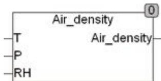
AIR\_DENSITY berechnet die Dichte der Luft in kg/m<sup>3</sup> abhängig von Druck, Feuchte und Temperatur. Die Temperatur wird in °C, Druck in Pascal und die Feuchte in % (50 = 50%) angegeben.
