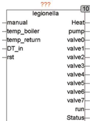
LEGIONELLA hat eine integrierte Schaltuhr, die an einem bestimmten Wochentag (DAY) zu einer bestimmten Tageszeit (T\_START) die Desinfektion startet. Hierzu ist die externe Anschaltung der Lokalzeit nötig (DT\_IN). Jederzeit kann mit einer steigenden Flanke an MANUAL die Desinfektion auch von Hand gestartet werden.
