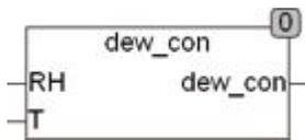
Der Baustein DEW\_CON berechnet aus der Relativen Feuchte (RH) und der Temperatur (T in °C) die Wasserdampfkonzentration in der Luft. Das Ergebnis wird in Gramm / m<sup>3</sup> ermittelt. RH ist in % (50 = 50%) anzugeben und die Temperatur in °C.
