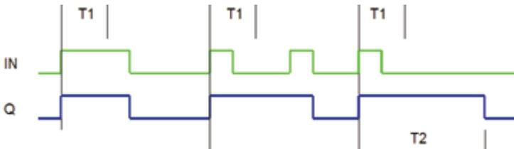
anliegt und den Ausgang Q der dem Eingang folgt. Anschließend wird am Eingang IN ein kurzer Puls (kürzer als T1) erzeugt und der Ausgang bleibt aktiv bis ihn ein weiterer Impuls an IN wieder löscht. Ein weiterer kurzer Impuls am Eingang IN setzt den Ausgang auf TRUE bis dieser nach Ablauf der Zeit T2 selbsttätig gelöscht wird.
