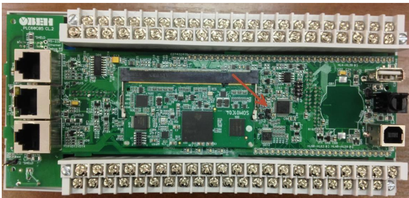
Рисунок 2.2а. Верхняя плата контроллера ПЛК110-60 [М02]
