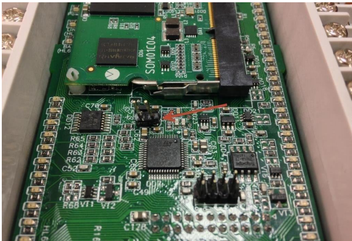
Рисунок 2.26. Перемычка XRP2 для ПЛК110-60 [M02]
