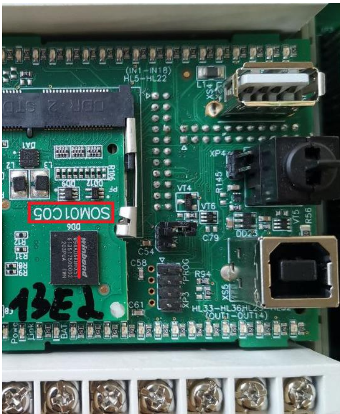
Рисунок 2.4.1. Плата SOM01C05, память Winbond
